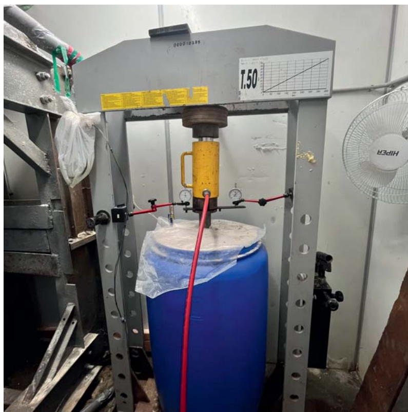
Рис. 5. Общий вид экспериментального лотка для определения несущей способности Fig. 5. Overall view of the test trough for determining bearing capacity
