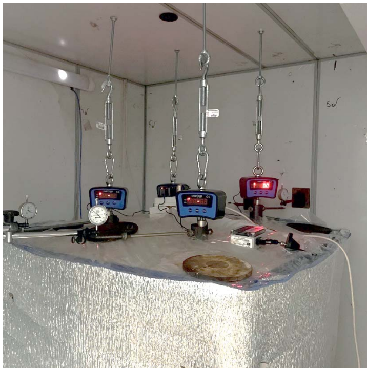
Рис. 7. Общий вид экспериментального лотка для определения негативной силы Fig. 7. Overall view of the test trough for determining negative force
