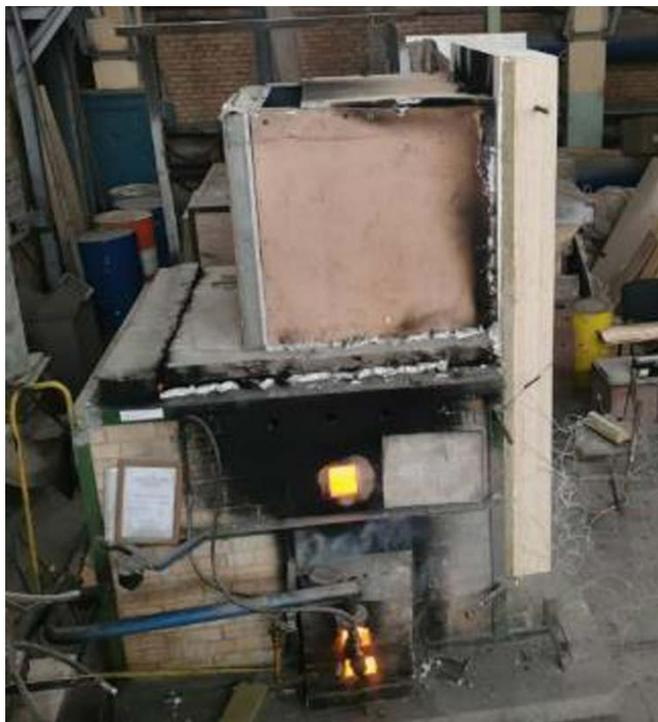
**Рис. 16.** Фрагмент конструкции стены с минераловатной плитой и двумя слоями ГКЛ во время испытаний
