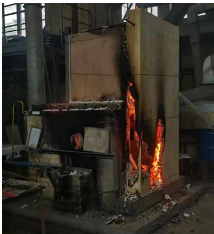
**Рис. 13.** Фрагмент конструкции стены с двумя слоями ГКЛ во время испытаний
