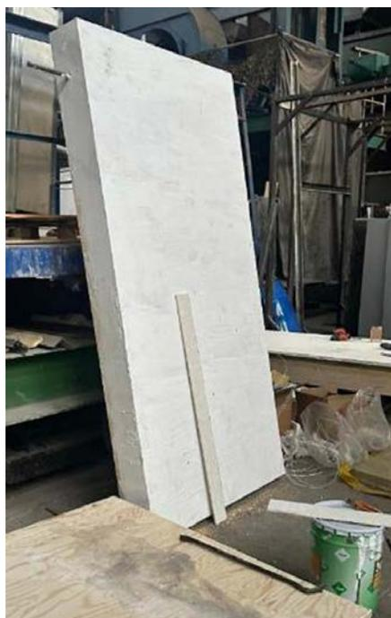
**Рис. 9.** Фрагмент конструкции стены с нанесенной огнезащитной краской перед испытаниями
