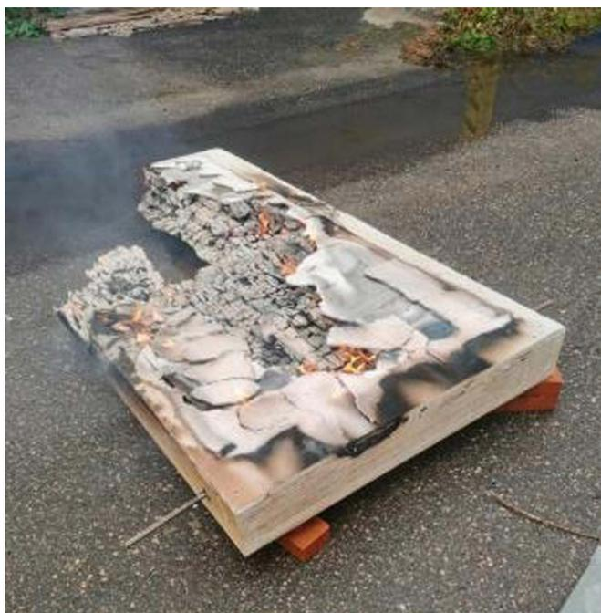
**Рис. 14.** Фрагмент конструкции стены с двумя слоями ГКЛ после испытаний
