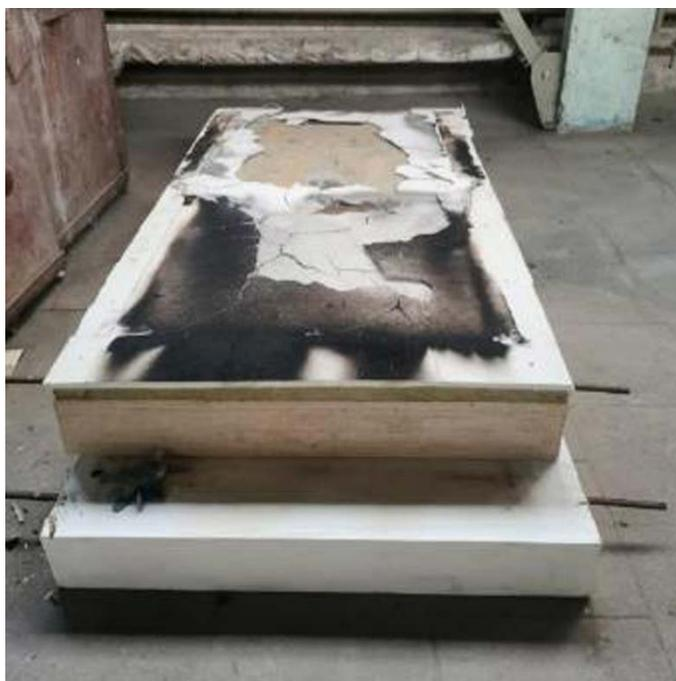
**Рис. 17.** Фрагмент конструкции стены с минераловатной плитой и двумя слоями ГКЛ после испытаний
