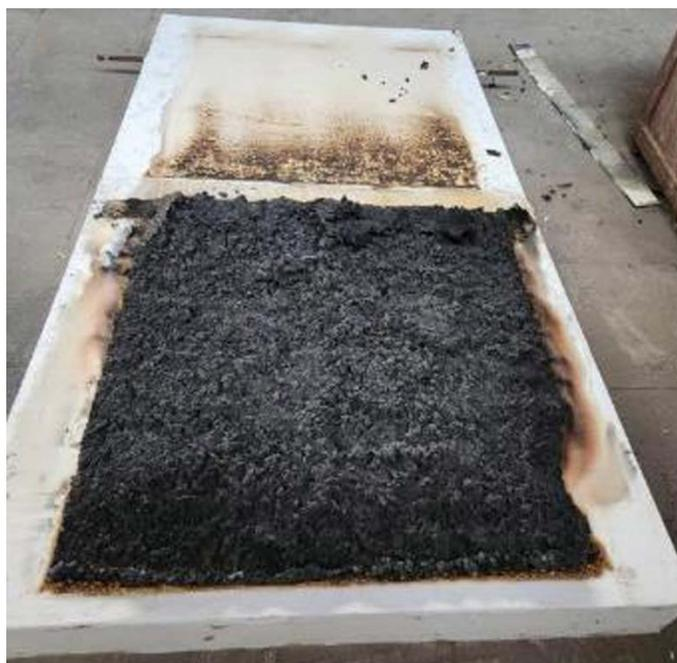
**Рис. 11.** Фрагмент конструкции стены с нанесенной огнезащитной краской после испытаний
