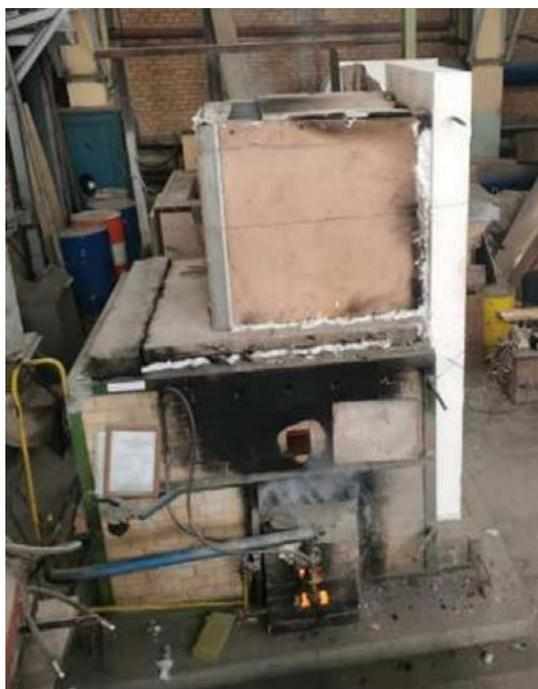
**Рис. 10.** Фрагмент конструкции стены с нанесенной огнезащитной краской во время испытаний
