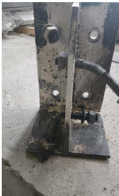
Рис. 7. Металлический узел крепления после проведения огневых испытаний
