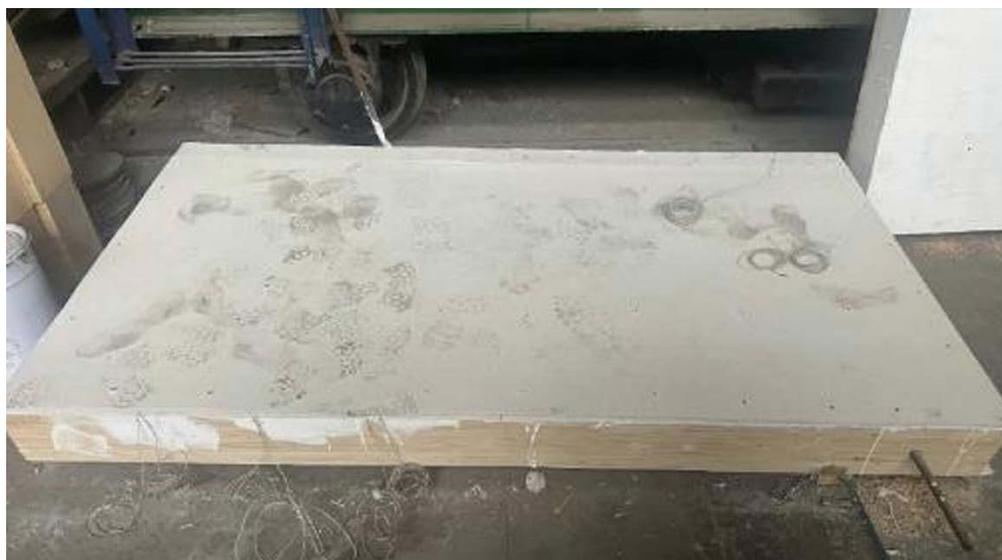
**Рис. 12.** Фрагмент конструкции стены с двумя слоями ГКЛ перед испытаниями
