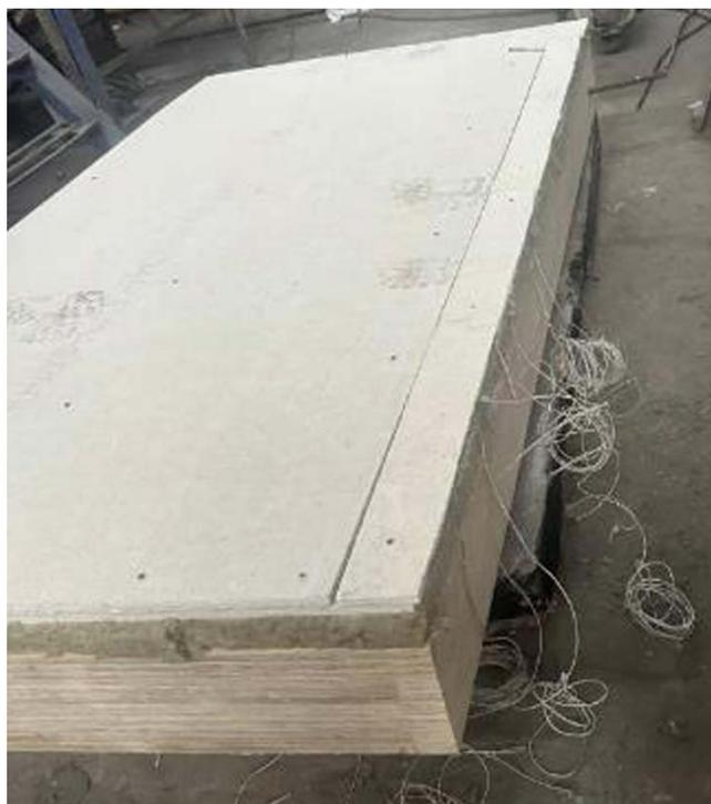
**Рис. 15.** Фрагмент конструкции стены с минераловатной плитой и двумя слоями ГКЛ перед испытаниями
