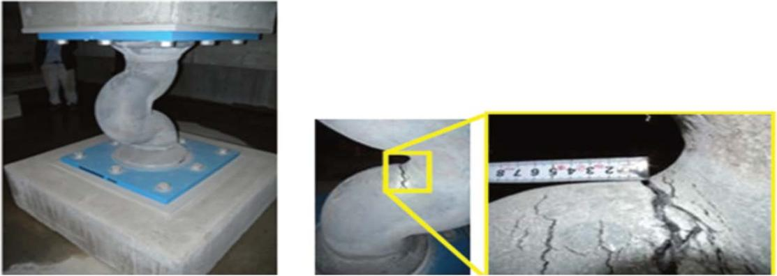
Рис. 7. Трещина на поверхности свинцового демфера [11]
