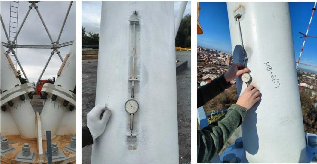
**Рис. 2.** Прикрепление приборов ТМИ-500М к различным элементам конструкций
