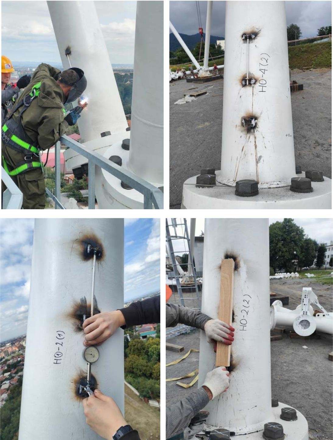
Рис. 9. Приварка элементов базы тензометра к конструкции башни и его настройка. Установка защитного устройства на тензомер
