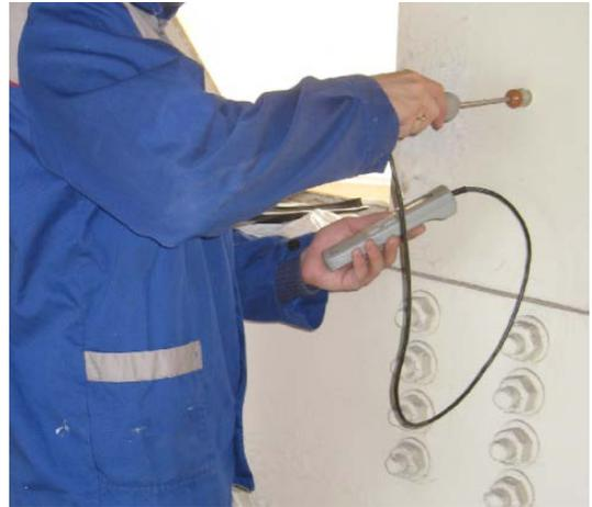
**Рис. 3.** Измерение температуры конструкции контактным термометром ТК5-01П
