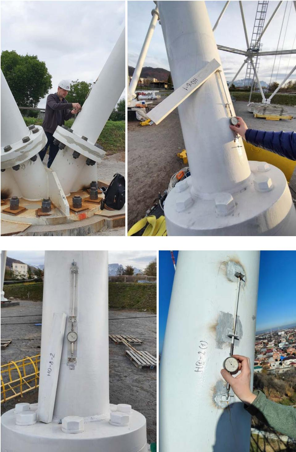
**Рис. 12.** Снятие показаний с деформометров
