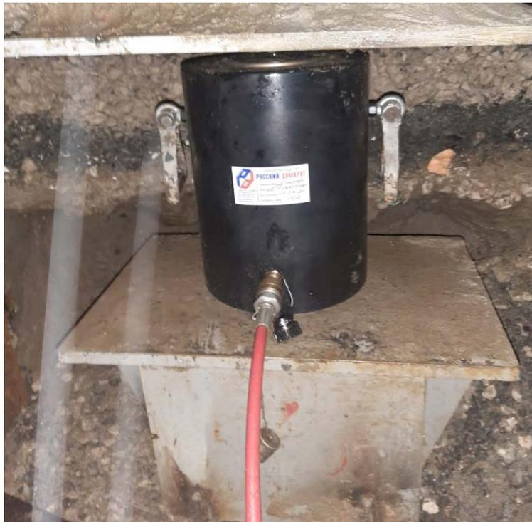
**Рис. 8.** Испытания свай (применяется домкрат грузоподъемностью 200 т)
