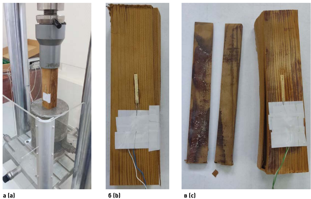
Рис. 3. Испытание деревянных образцов на сжатие: а – образец в прессе П-500; б – общий вид разрушения термообработанного образца; в – общий вид разрушения термообработанного и стабилизированного образца Fig. 3. Compression testing of wooden specimens: a – specimen in the P-500 press; b – general view of the failure of a thermally treated specimen; c – general view of the failure of a thermally treated and stabilized specimen
