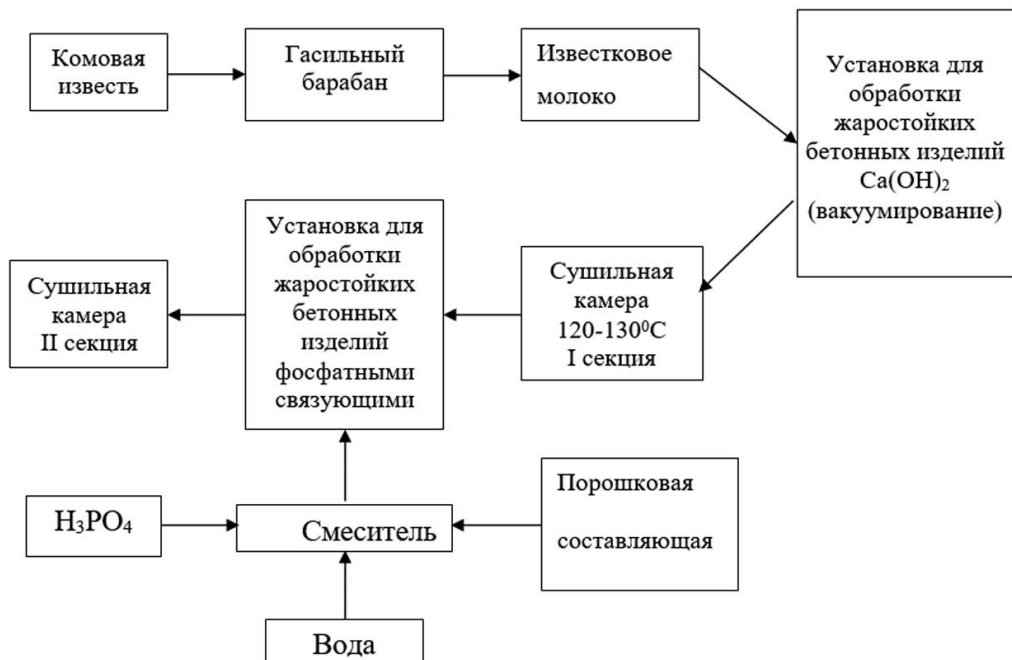
Рис. 3. Технологическая схема структурной модификации жаростойких композитов
