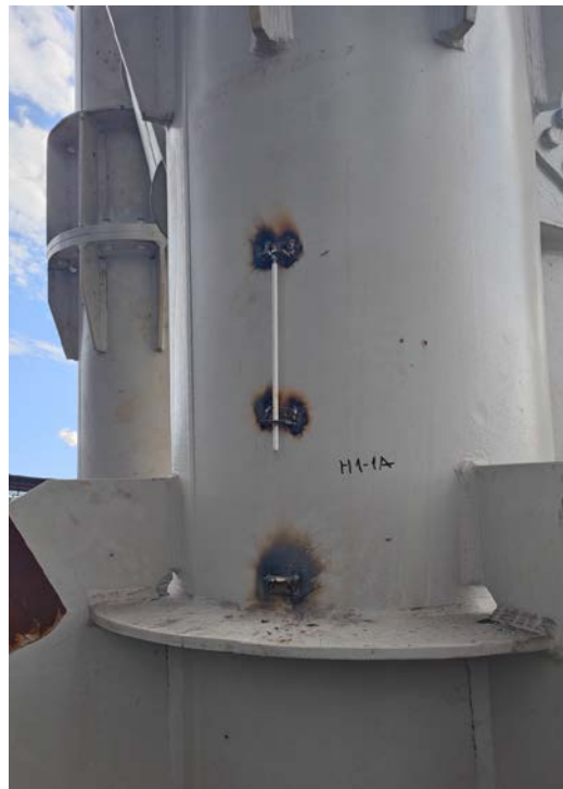
Рис. 4. Установленное приспособление под механический тензометр перед настройкой Fig. 4. Fixture installed for mechanical strain gauge before adjustment
