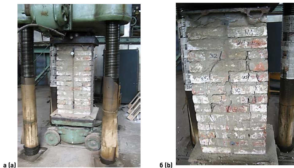
Рис. 5. Образец серии БТ-Иэп-тр: а – в процессе испытания; б – после испытания Fig. 5. BT-Iep-tr series masonry sample: a – during testing; b – after testing
