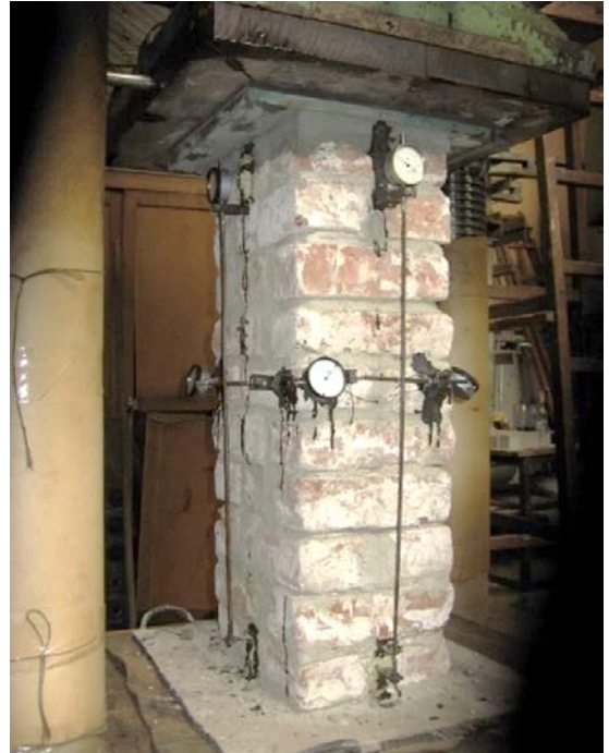
Рис. 2. Образец серии М1 в гидравлическом прессе Fig. 2. M1 series masonry sample in a hydraulic press
