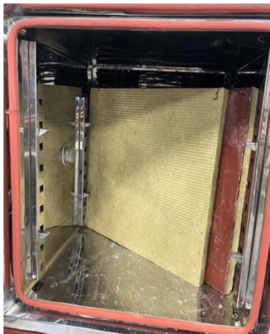
Рис. 1. Образцы в климатической камере TN-225 С перед началом испытаний
