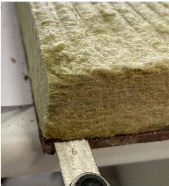
Рис. 6. Состояние системы покрытия после 100 циклов старения
