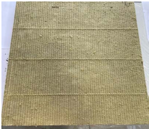
Рис. 3. Состояние системы покрытия после 25 циклов старения
