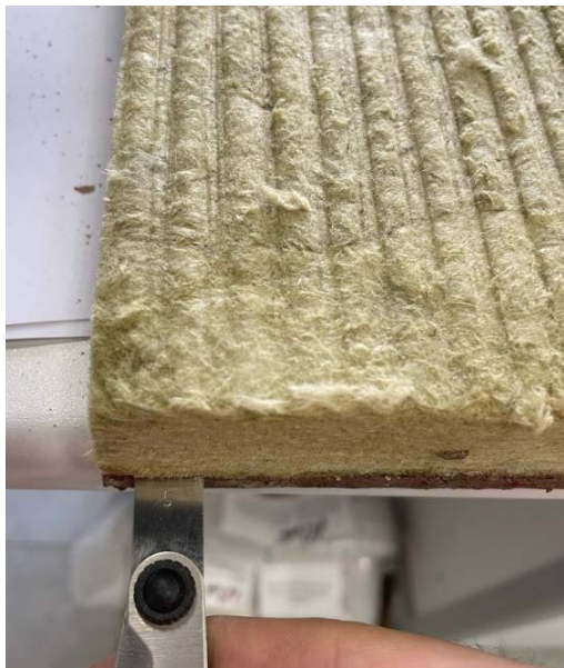
Рис. 5. Состояние системы покрытия после 75 циклов старения
