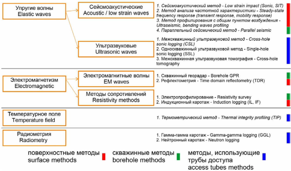
Рис. 1. Методы неразрушающего контроля качества свай (с изменениями, из [6]), сгруппированные согласно используемому физическому принципам
