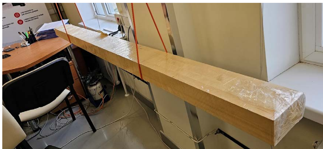
Рис. 6. Вывешивание деревянного образца размером 2200 × 150 × 75 мм
