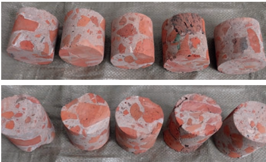
Рис.6. Общий вид образцов бетона из распиленных кернов
