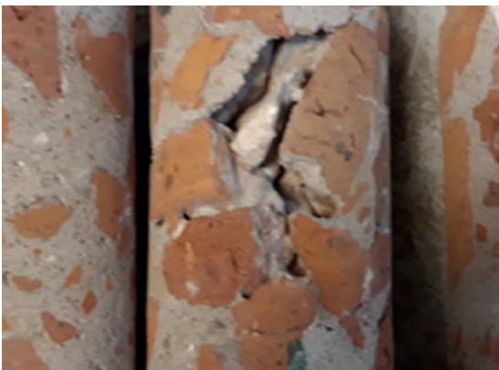
Рис.5. Общий вид структурных дефектов (полостей и пустот) в бетоне плиты
