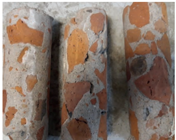
Рис.4. Общий вид выбуренных из фрагментов бетона кернов
