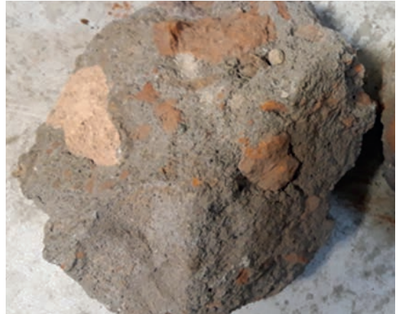
Рис.3. Общий вид отобранных из плиты перекрытия реконструируемого здания фрагментов бетона
