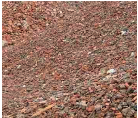
Рис.2. Общий вид рециклингового щебня из боя керамического кирпича, полученного дроблением кирпичной кладки на основе керамического кирпича, керамических камней, а также бетонных и железобетонных конструкций с заполнителями из боя керамического кирпича
