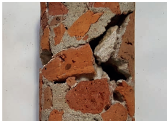
Рис.5. Общий вид структурных дефектов (полостей и пустот) в бетоне плиты
