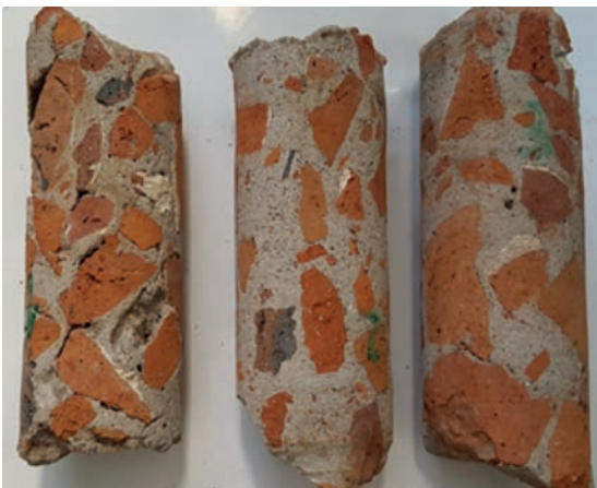
Рис.4. Общий вид выбуренных из фрагментов бетона кернов
