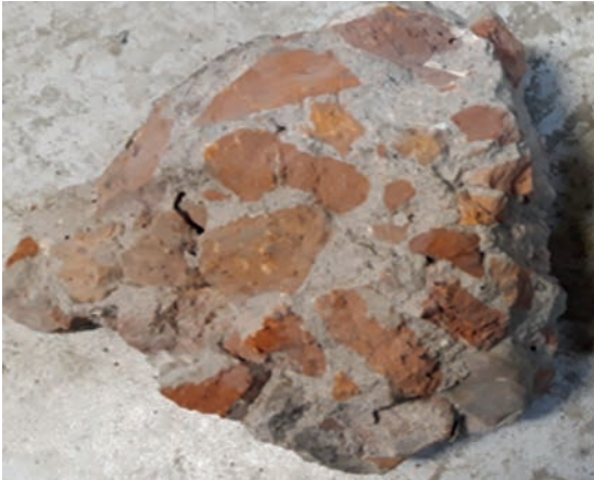
Рис.3. Общий вид отобранных из плиты перекрытия реконструируемого здания фрагментов бетона
