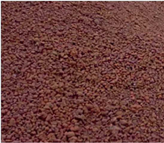
Рис.1. Общий вид рециклингового щебня из боя керамического кирпича, полученного дроблением некондиционного керамического кирпича и керамических камней
