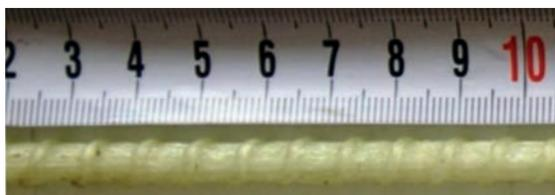
**Рис.4.** Внешний вид стержня композитной арматуры, партия №3
