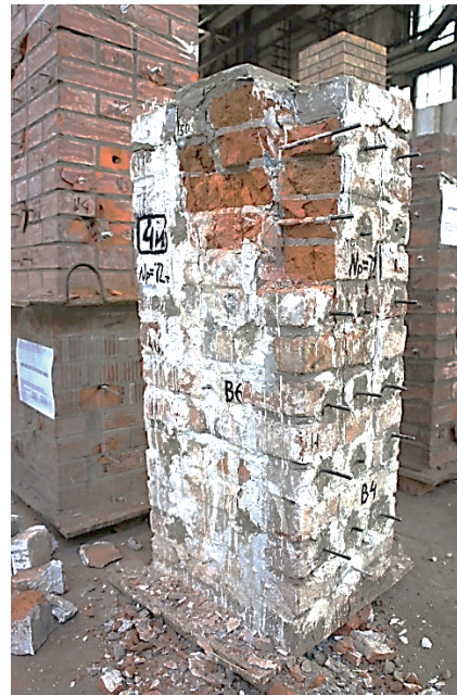
Рис. 12. Образец из исторического кирпича, получивший трещины после 1-го этапа испытаний на местное сжатие (а), образец, усиленный инъекцией раствора и косвенным армированием, после 2-го этапа (б) Fig. 12. Sample made of historical brick, which received cracks after the 1st stage of local compression tests (a), reinforced with mortar injection and indirect reinforcement, after the 2nd stage (b)
