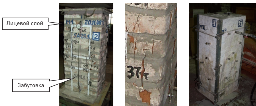
Рис. 9. Образцы серии Забут-ЦС, испытываемые равномерно распределенной нагрузкой: а – после первого этапа испытаний; б – инъекция кладки перед вторым этапом испытаний Fig. 9. Specimens of the Zabut-CS series tested with a uniformly distributed load: а – after the first stage of testing; б – injection of masonry before the second stage of testing
