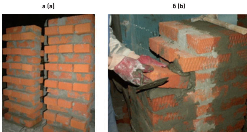
Рис. 13. Изготовление образцов, имитирующих восстановление «старой» кладки «новой» кладкой: а – образцы, имитирующие «старую» кладку; б – устройство «новой» кладки Fig. 13. Manufacturing of samples simulating the restoration of "old" masonry with "new" masonry: a – samples simulating "old" masonry; b – construction of "new" masonry
