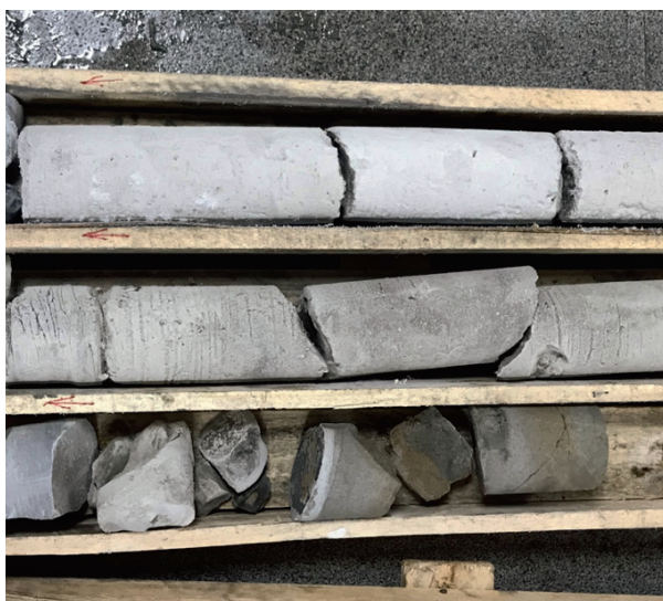
Рис. 4а. Керны – струйная цементация Fig. 4а. Cores – jet grouting
