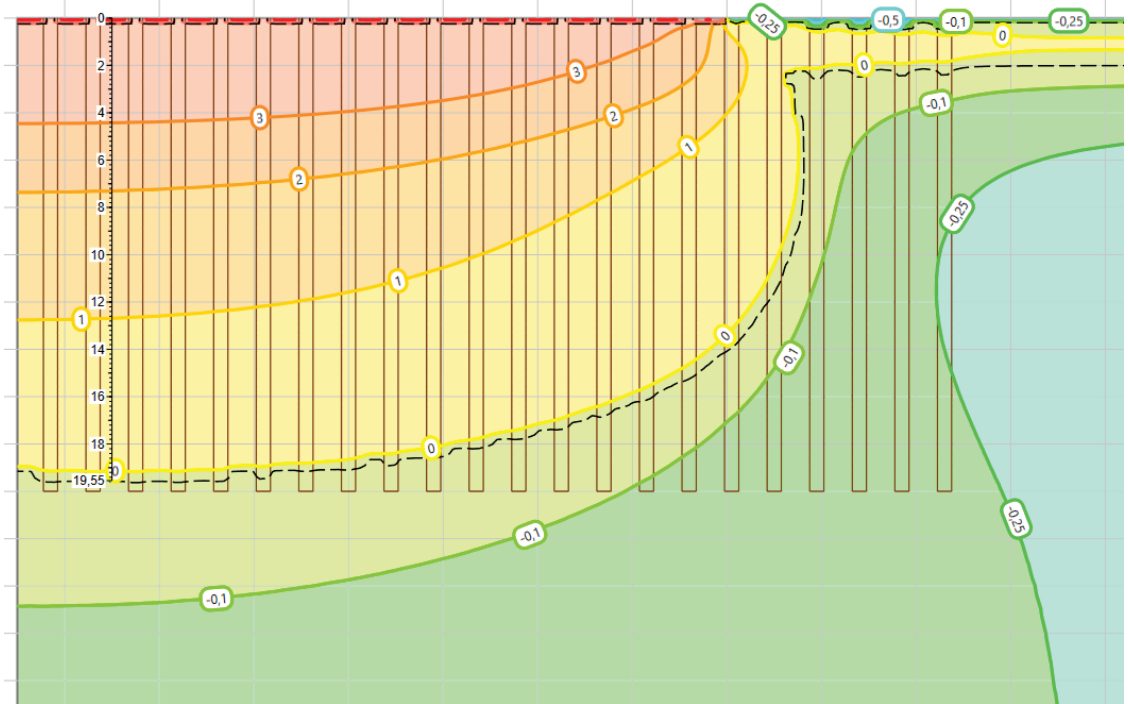
Рис. 16. Температурное распределение закрепленного грунта на конец срока эксплуатации Fig. 16. Temperature distribution of the fixed soil at the end of the service life
