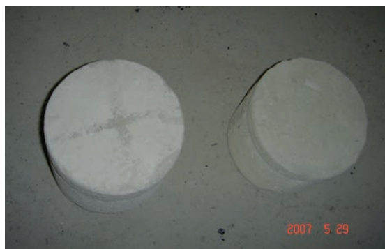
Рис.3. Образцы-kerne пенобетона различной прочности
