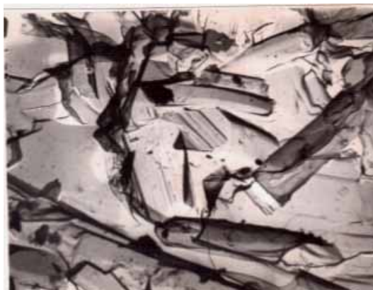
Рис. 1. Электронно-микрофотография образца из отливки высокопрочного гипса добавкой 5 вес. % извести негашеной молотой
