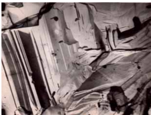
Рис. 3. Электронно-микрофотография пробы гипсовой отливки из высокопрочного гипса с добавкой 10 вес. % извести негашеной молотой, хранившейся в воздушно-сухих условиях
