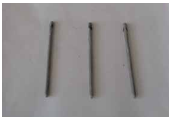
Рис. 8. Состояние стержней из образцов цементно-песчаной смеси через 6 месяцев в режиме увлажнения – высушивания
