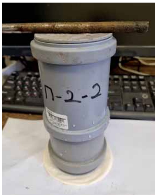
Рис. 7. Состояние стального стержня после 3 месяцев выдержки в среде неполного водонасыщения в грунте – засоленный песок с содержанием 0,25 % хлористого натрия
