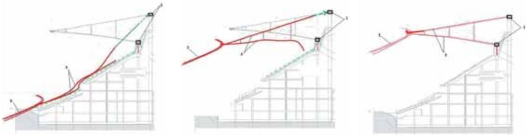
**Рис.11.** Схема монтажа вантового покрытия типа «велосипедное колесо»: *а-в* — этапы монтажа; 1 – наружный опорный контур; 2 – внутреннее растянутое кольцо; 3 – элементы радиальных вант
