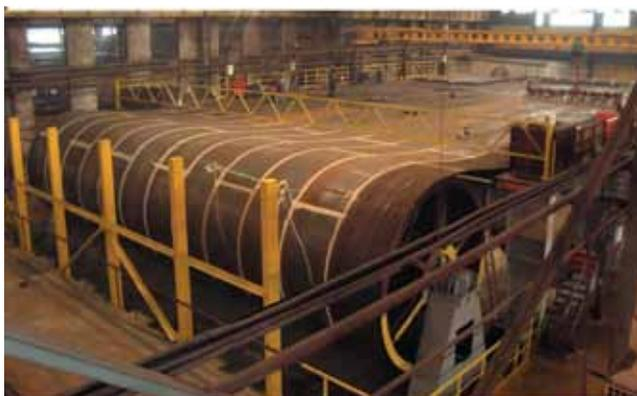
**Рис.13.** Установка для изготовления рулонных полотнищ
