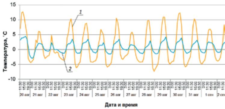
**Рис.3.** Перепад температуры кладки лицевого слоя, расположенного с солнечной стороны (1) и в тени (2), по его толщине в теплое время года в течение суток
