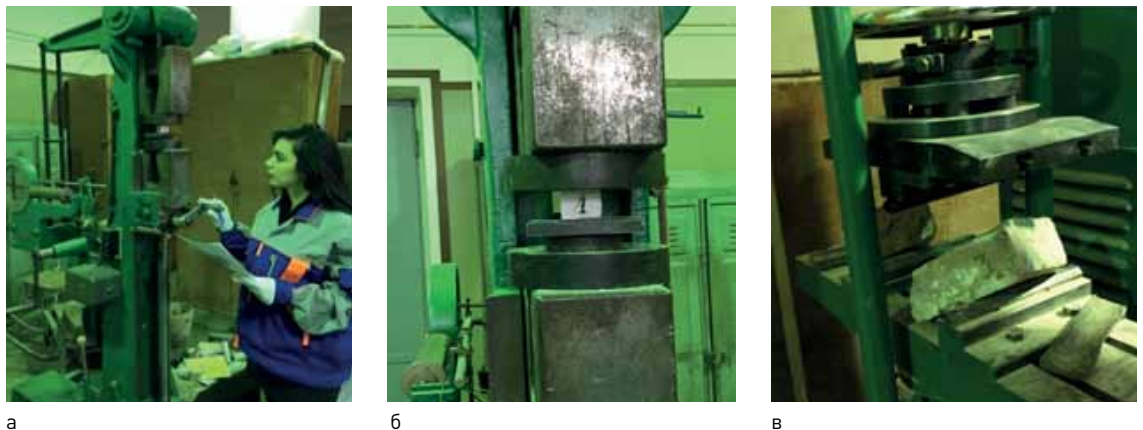
Рис.3. Проведение испытаний образцов раствора (а, б) и кирпича (в)
