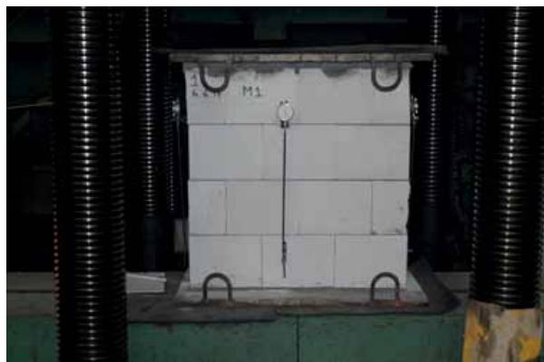
Рис. 4. Опытный кладочный стеновой образец №1, изготовленный из силикатных блоков на швах толщиной 3–4 мм из клеевого раствора перед проведением испытаний
