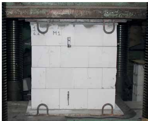
Рис. 5. Опытный кладочный стеновой образец №1, изготовленный из силикатных блоков на швах толщиной 3–4 мм из клеевого раствора после испытаний
