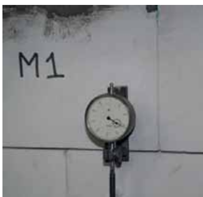
Рис.3. Индикатор часового типа, установленный на образец из силикатных блоков на швах из клеевого раствора толщиной 3–4 мм
