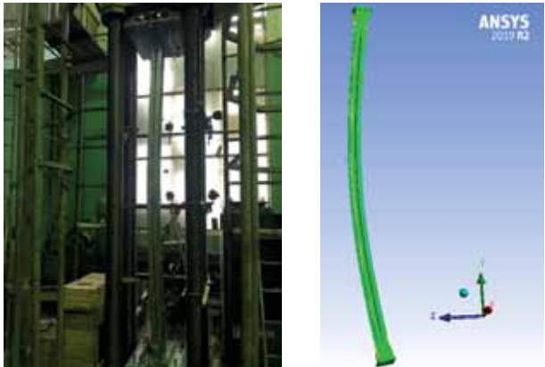
Рис.9. Форма разрушения составной стойки из профилей 2xAC150x45x12x1,6 (потеря общей устойчивости)
