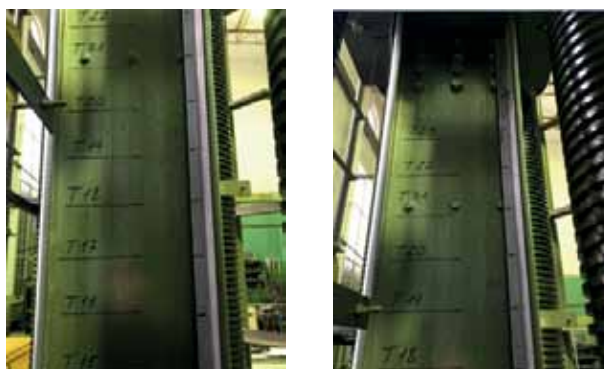
Рис.4. Испытываемые образцы с контрольными точками для замера перемещений. Разметка, нанесенная на поверхность образцов
