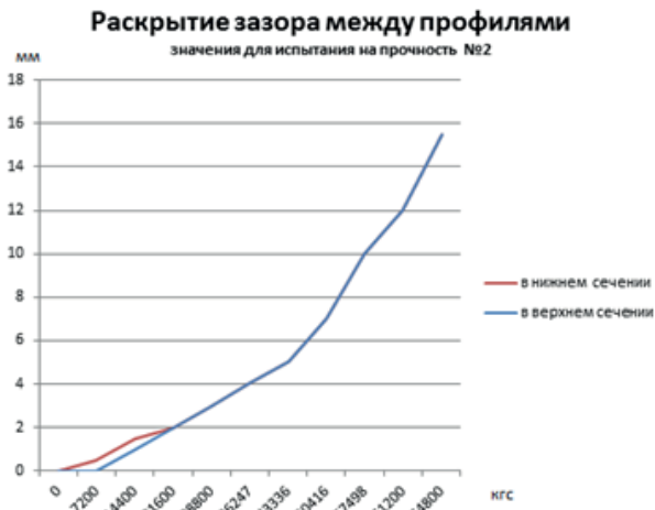
Рис.14. Перемещение профилей стойки на участках между болтовыми соединениями. Зависимость «нагрузка– деформация» для составной стойки из профилей 2×АС360×125×30×3,5
