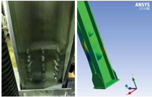
Рис.11. Форма разрушения составной стойки из профилей 2 \times \text{AC}300 \times 90 \times 20 \times 3,0 (потеря местной устойчивости профиля в опорной зоне)
