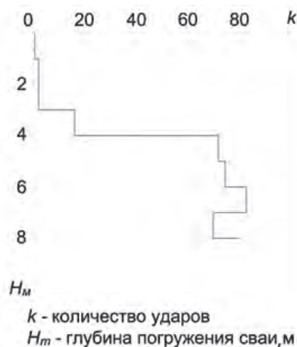
Рис. 4. Ходограмма забивки одной из свай на площадке строительства в CAO г. Москвы
