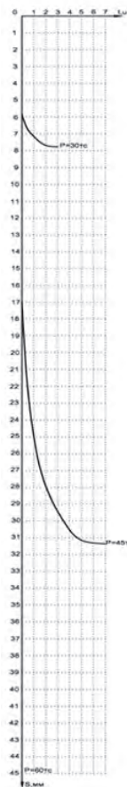
Рис. 8. График изменения осадки сваи S во времени t (по ступеням нагрузок) испытываемой сваи с уширением на строительной площадке в городе Тула
