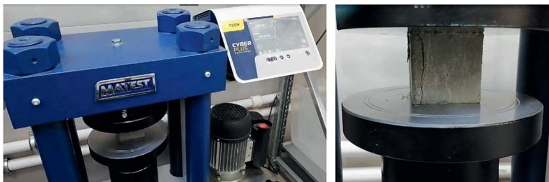
**Рис. 3.** Испытание образца на сжатие
