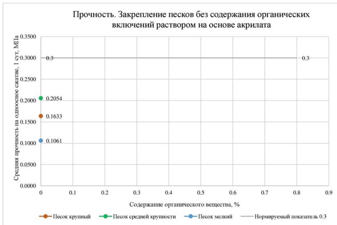
**Рис. 8.** Прочность. Закрепление песков без содержания органических включений раствором на основе акрилата
