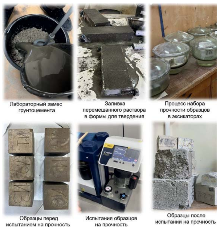
Рис. 1. Процесс изготовления, твердения и испытания образцов грунтоцемента Fig. 1. Process of manufacturing, hardening and testing jet grouted material samples
