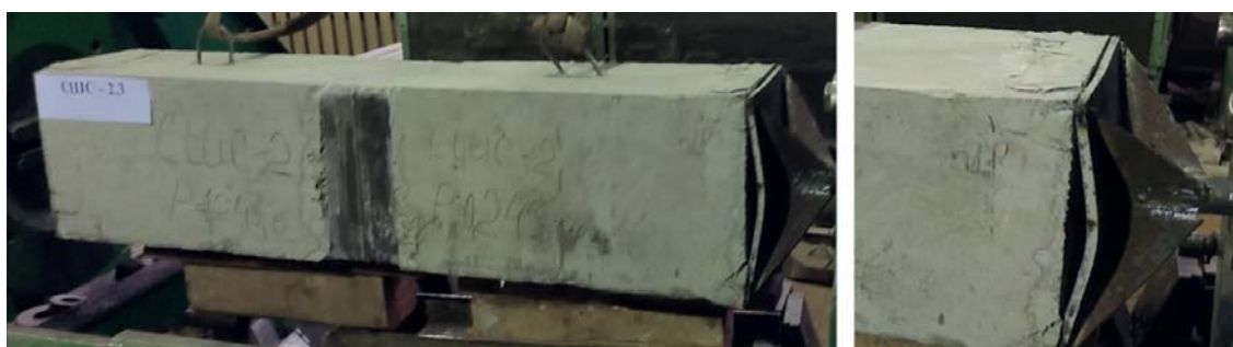
Рис. 5. Общие виды испытаний образцов серии СШС-2 при растяжении (разрушение образцов не достигнуто – отказ происходил по потере несущей способности специальных торцевых закладных деталей для фиксации в захватах испытательной машины) Fig. 5. General views of the series 2 sample tensile testing (no destruction of samples was achieved – the failure occurred due to the loss of the bearing capacity of the special embedments for the fixation in the grips of the testing machine)
