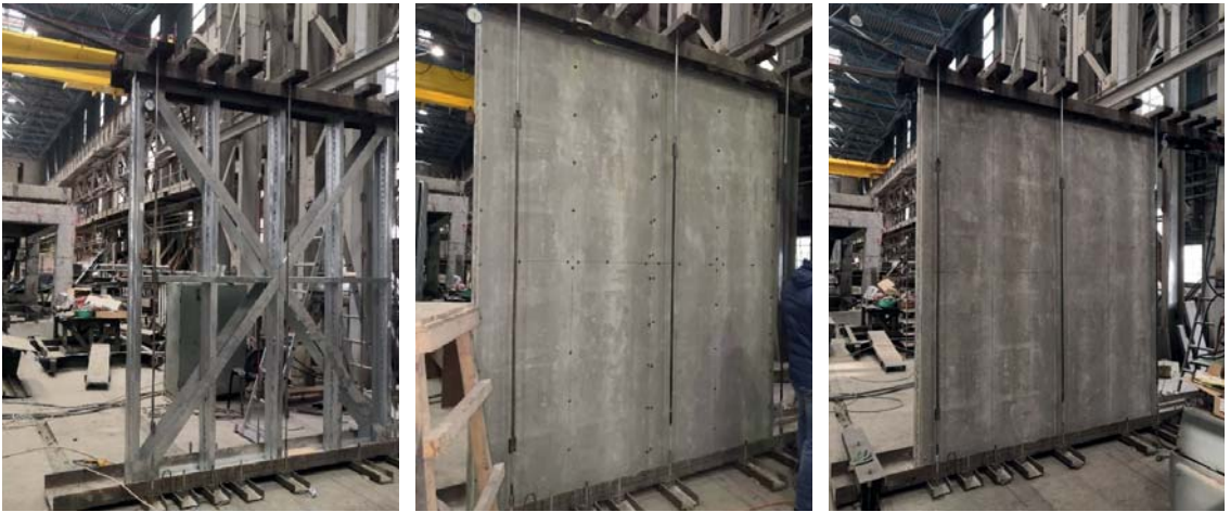
Рис. 13. Общий вид экспериментальных образцов стеновых панелей из ЛСТК: а – с вертикальной X-образной связью; б – с однослойной наружной панелью обшивки из ЦСП толщиной 10 мм; в – с двухслойной наружной панелью обшивки из ЦСП толщиной 20 мм
