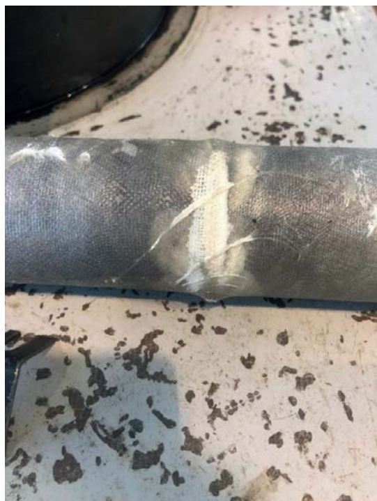
Рис. 9. Зона дефекта сварного шва после проведения эксперимента Fig. 9. Weld joint defect area after experiment
