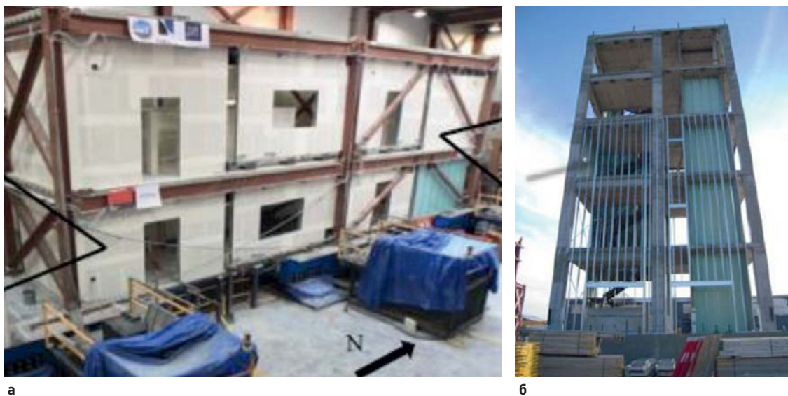
а Рис. 9. Экспериментальные образцы моделей и фрагментов зданий с несущими конструкциями из ЛСТК, испытанных на сейсмоплатформах: а – двухэтажное здание со стальным каркасом, включающее перегородки и потолочные системы из ЛСТК [43]; б – пятиэтажное железобетонное здание, включающее перегородки и фасадные системы [45] Fig. 9. Experimental models and fragments of buildings with non-load-bearing LGFS structures tested on shake table: a – e two-storey building having steel frame including LGFS partition walls and ceiling systems [43]; b – five-storey reinforced concrete building including partition walls and facade systems [45]
