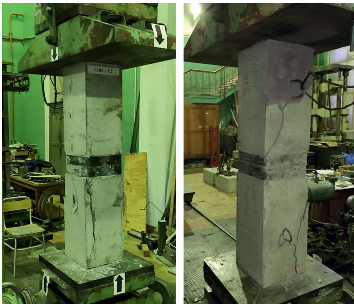
Рис. 4. Характерная схема разрушения опытных образцов серии СШС-1 при сжатии Fig. 4. Characteristic destruction scheme of series 1 samples under compression
