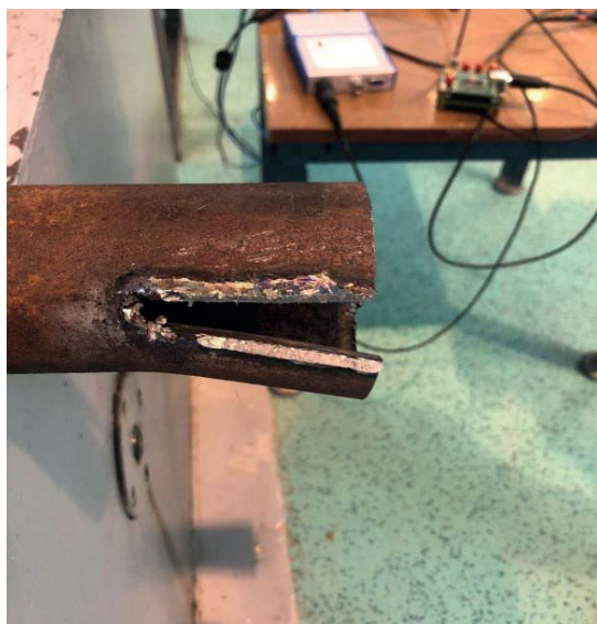
Рис. 8. Разрушение сварного шва оснастки Fig. 8. Failure of fitting weld joint
