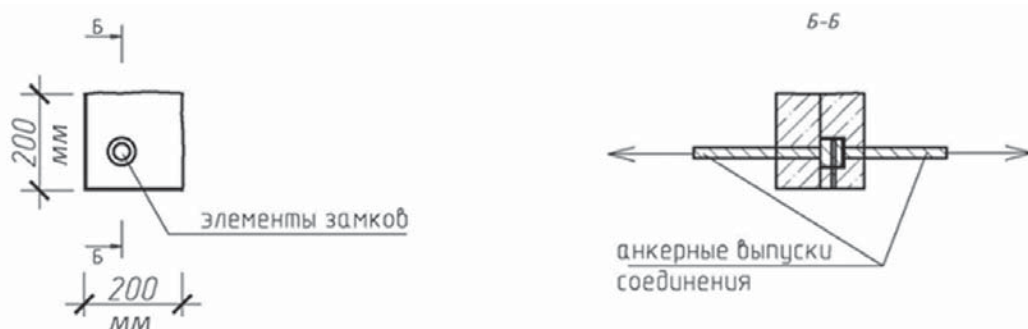
Рис. 3. Принципиальная конструкция фрагмента опытного образца и схема приложения растягивающей нагрузки
