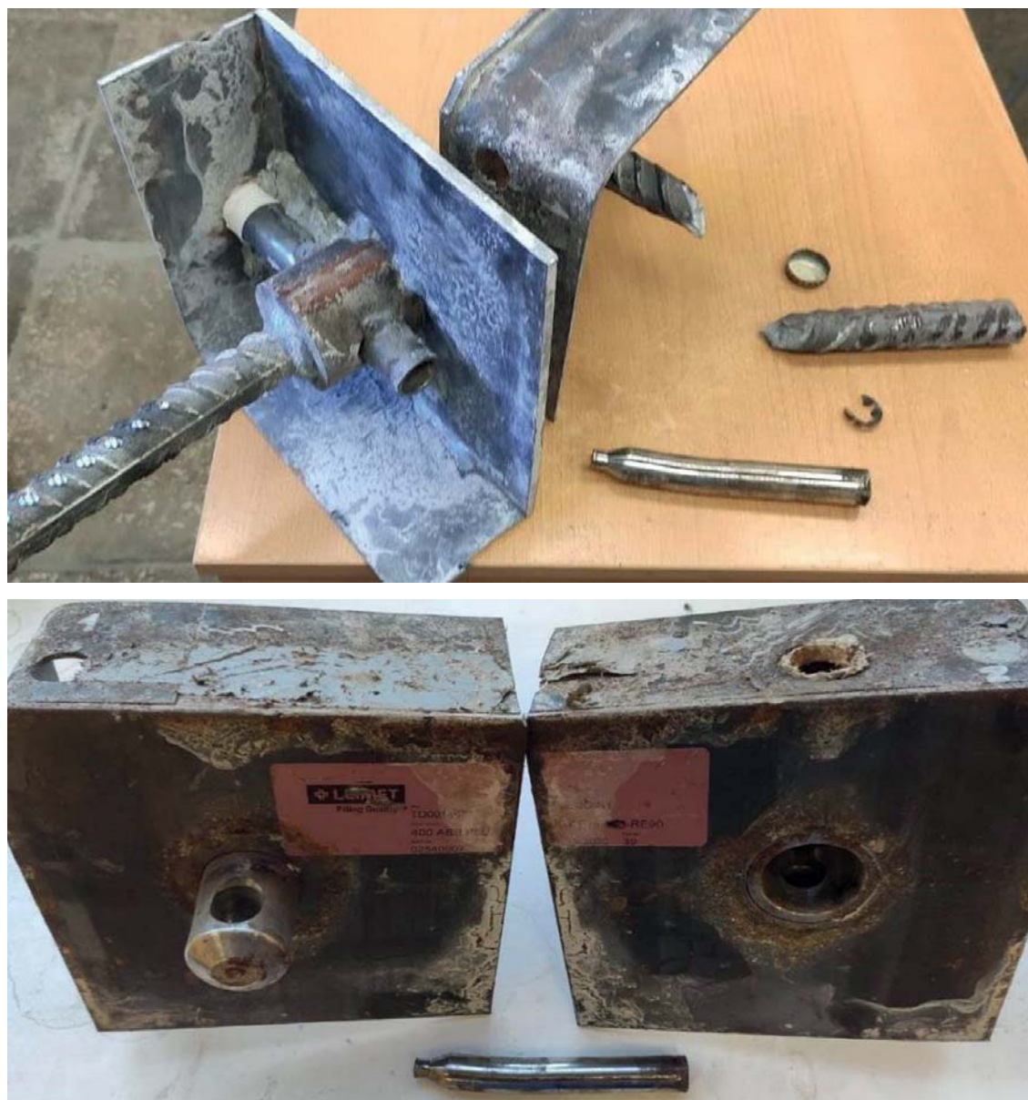
Рис. 5. Общий вид элементов штифтового соединения после испытаний на разрыв (в разобранном виде) и характерная схема его разрушения при действии осевой растягивающей нагрузки Fig. 5. General view of pin joint elements after tensile tests (disassembled) and the characteristic diagram of the pin joint destruction under the effect of the axial tensile load
