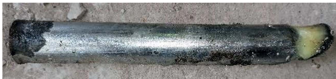
Рис. 7. Общий вид и характерные повреждения элементов штифтового соединения (в разобранном виде) образцов серии № 2 после ускоренных коррозионных испытаний при режиме № 2 в течение 90 суток: а – торцевая пластина с фиксирующим штырем; б – торцевая пластина с фиксирующим пазом; в – забивной штифт
