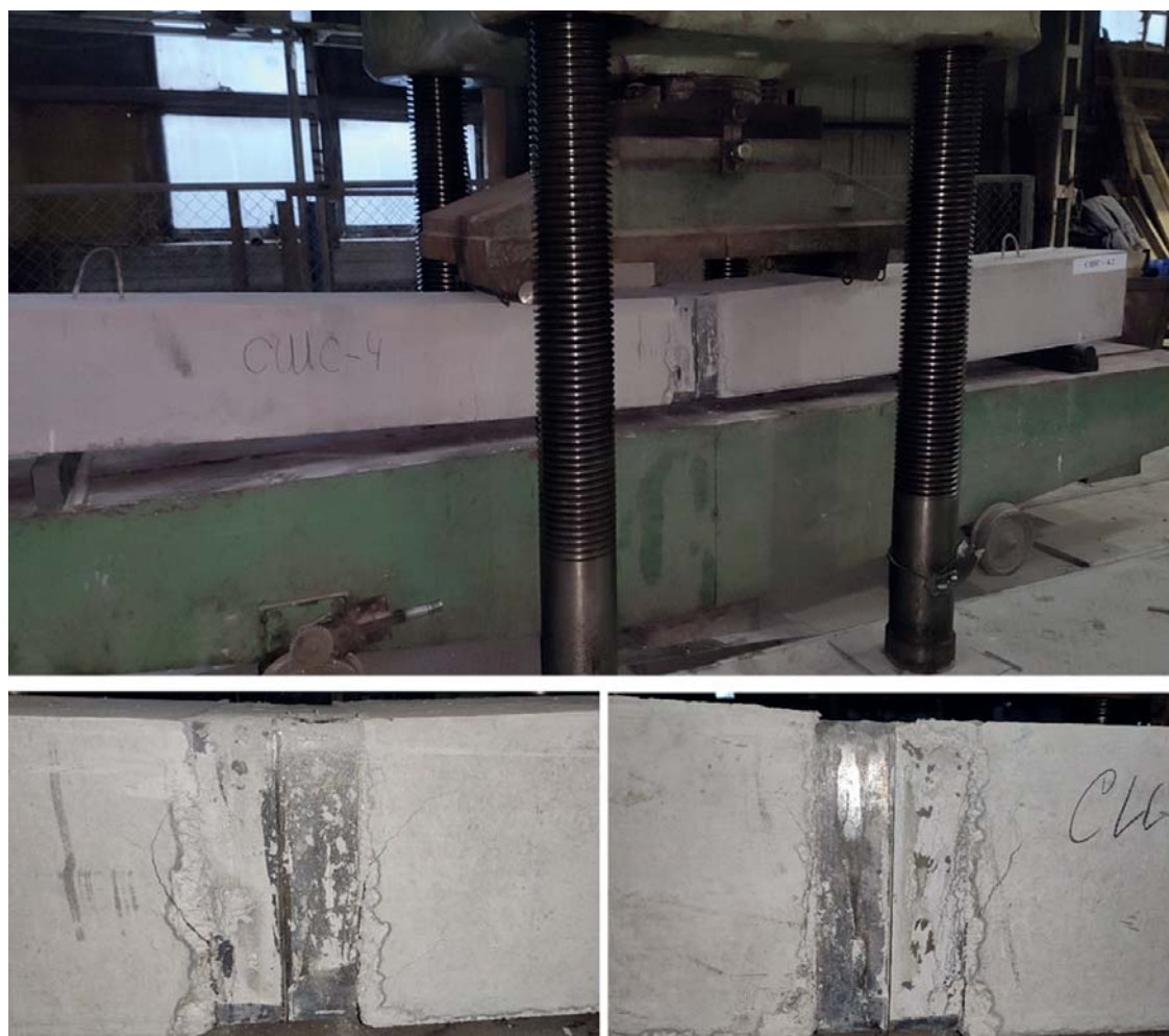
Рис. 7. Характерная схема разрушения опытных образцов серии СШС-4 при изгибе Fig. 7. Characteristic destruction scheme of series 4 samples under the bending
