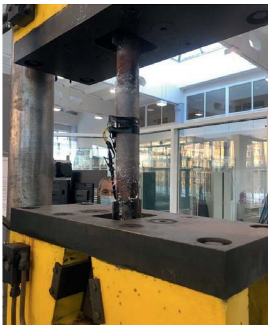
Рис. 6. Установка образца на разрывную машину для статических испытаний металлов Р-100 Fig. 6. Installation of a specimen on R-100 tensile testing machine for static testing of metals
