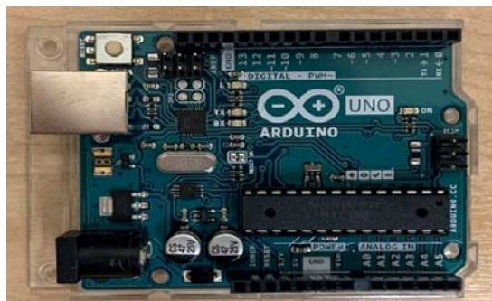
Рис. 2. Печатная плата Arduino Uno Fig. 2. Arduino Uno printed circuit board
