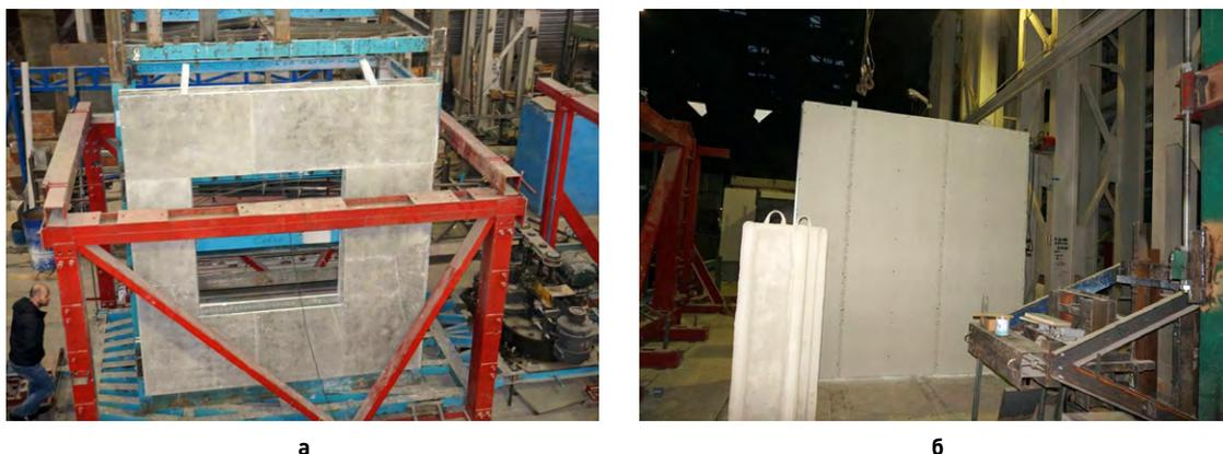
**Рис. 8.** а – Экспериментальный образец фасадной панели в процессе динамических испытаний;
