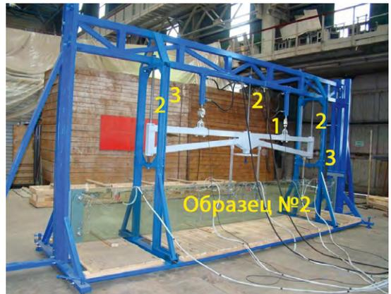
1 – траверса, передающая нагрузку на балку; 2 – фиксирующая вертикальная направляющая;
