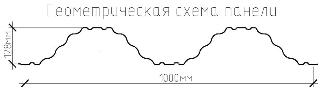
**Рис. 2.** Схема волнистого профилированного листа с двойным гофрированием
