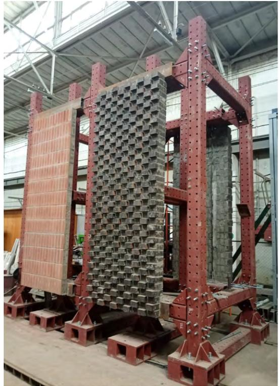
**Рис. 2.** Стенд ИС-4 по испытанию крупноформатных образцов фасадных конструкций со смонтированными образцами различных защитно-декоративных конструкций из кирпича
