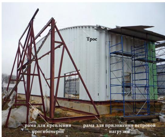
**Рис. 1.** Общие виды испытываемого фрагмента
