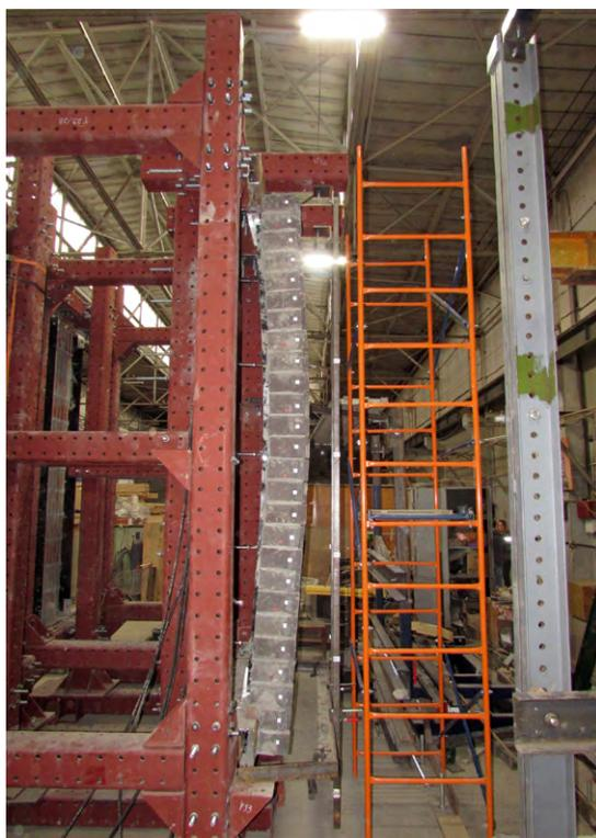
**Рис. 7.** Общий вид экспериментального образца на металлических подконструкциях после проведения испытаний
