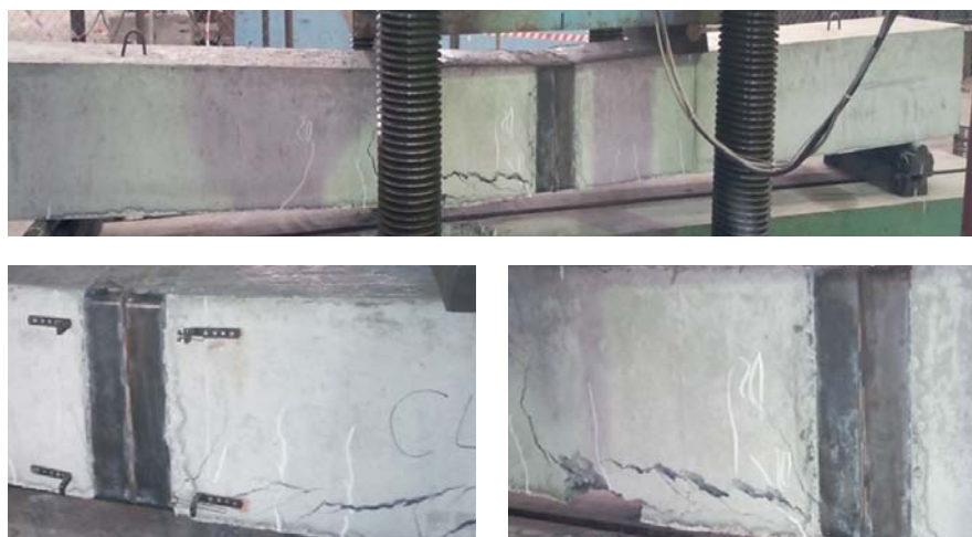
Рис. 6. Характерная схема разрушения опытных образцов серии СШС-4.4-4 при изгибе
