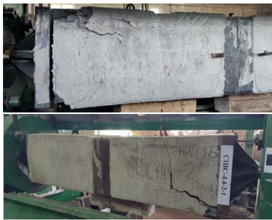
Рис. 4. Общие виды испытаний образцов серии СШС-4.4-2 при растяжении
