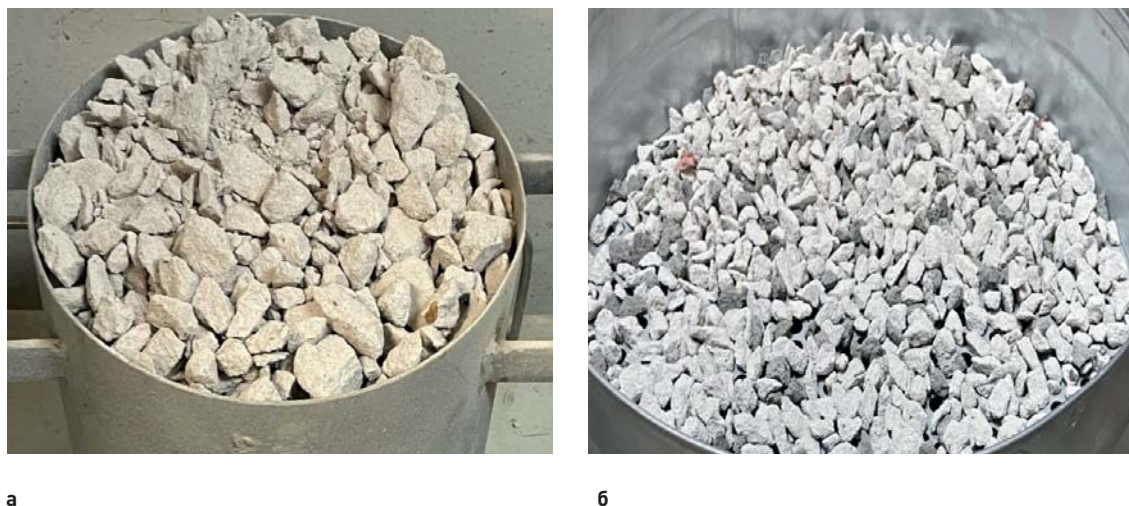
Рис. 2. Общие виды рециклингового щебня из боя силикатного кирпича: а – рециклинговый щебень, полученный из кирпича (без раствора); б – рециклинговый щебень, полученный из кирпичной кладки с раствором Fig. 2. General view of recycled crushed aggregate from crushed sand-lime brick: а – recycled crushed aggregate from bricks (open stone mix); б – recycled crushed aggregate from brickwork (containing mortar)
