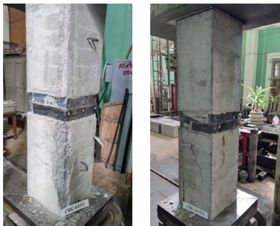
Рис. 3. Характерная схема разрушения опытных образцов серии СШС-4.4-1 при сжатии
