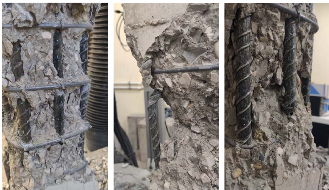
Рис. 3. Типовая картина разрушения опытных образцов Fig. 3. Typical view of test sample crushing
