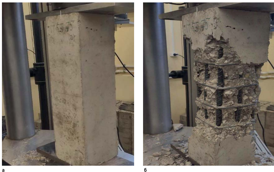
Рис. 2. Общие виды испытаний опытного образца серии П. 55.75: а – образец при нагрузке, равной половине от разрушающей; б – разрушенный образец Fig. 2. General tests of the P.55.75 test sample: a – sample with load equal to half of crushing load, b – crushed sample
