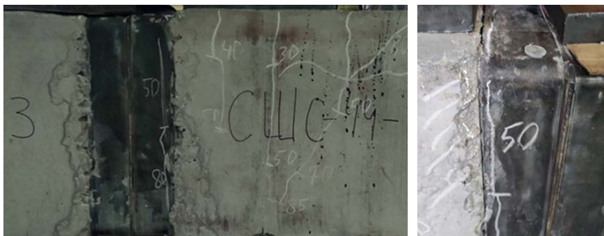
Рис. 5. Характерная схема разрушения опытных образцов серии СШС-4.4-3 при поперечном сдвиге
