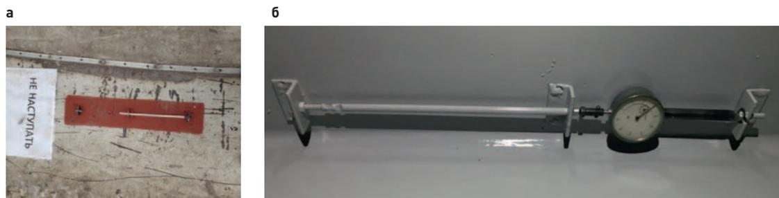
**Рис. 9.** Механический тензометр
