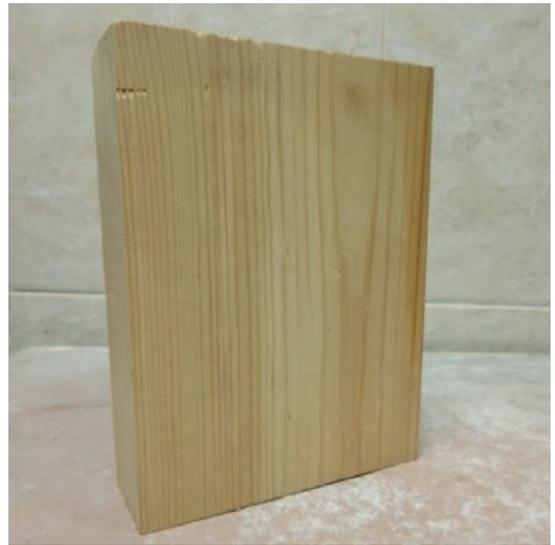
Рис. 1. Деревянный образец для проведения испытания
