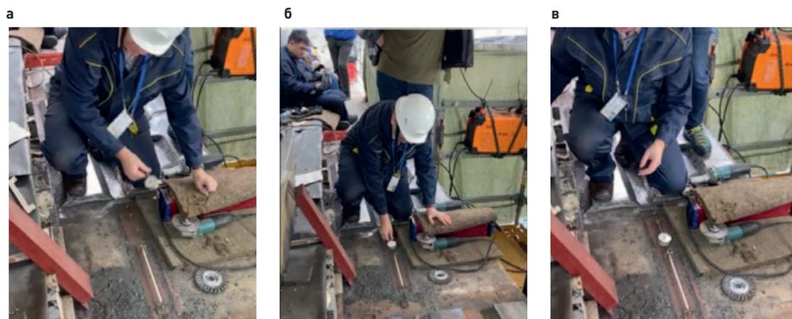
**Рис. 10.** Процесс измерения деформаций (напряжений) в конструкциях внутреннего контура покрытия «Газпром Арена»
