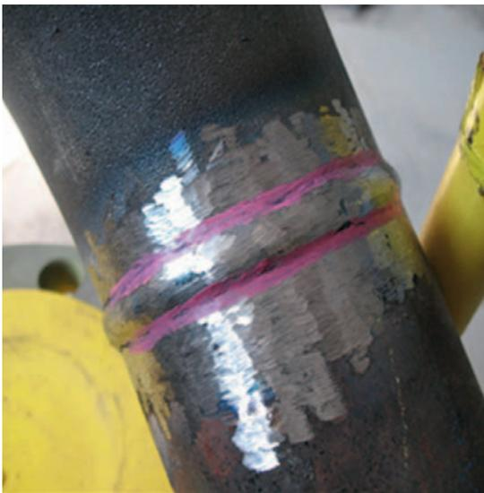
**Рис. 6.** Цветная дефектоскопия сварного соединения
