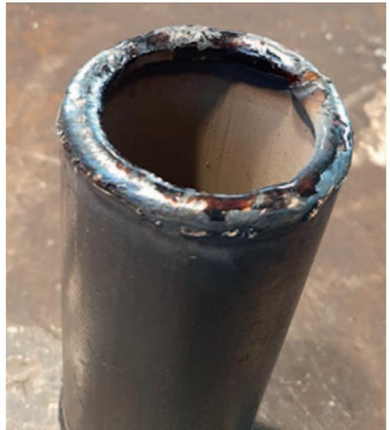
**Рис. 2.** Предварительная наплавка кромки «старой» трубы
