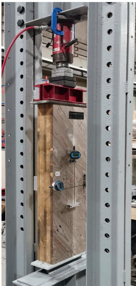
Рис. 4. Общий вид испытательного стенда для определения модуля сдвига в плоскости плиты
