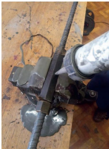
**Рис. 4.** Резьбо-клеевые соединения
