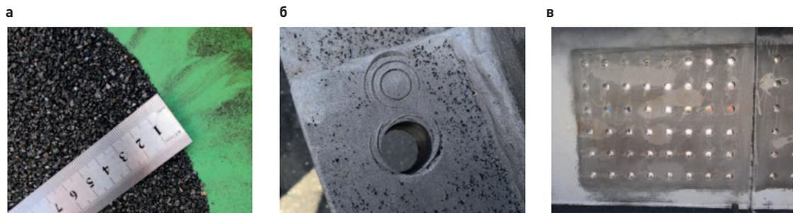
**Рис. 3.** Общий вид фрикционных поверхностей после обработки купершлаком:
