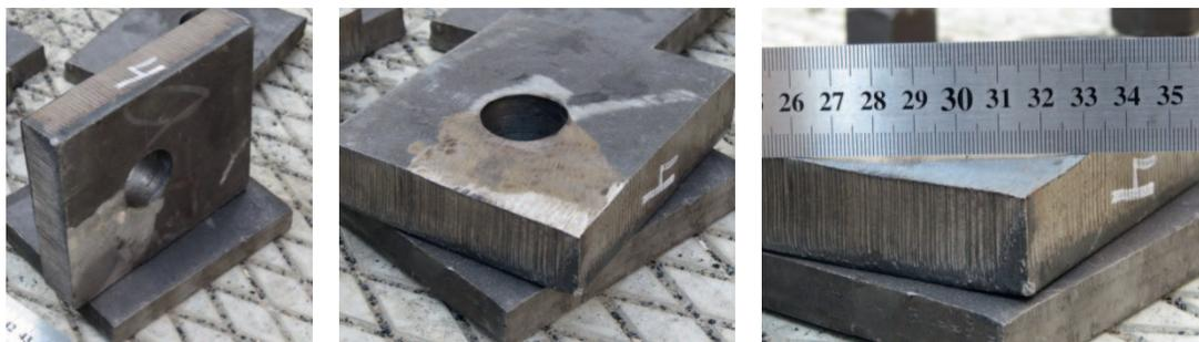
**Рис. 5.** Общий вид элементов образца с искусственно созданным дефектом вокруг отверстия для болта
