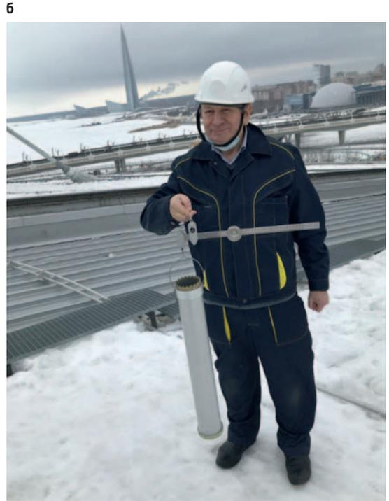
**Рис. 12.** Измерение снеговой нагрузки на покрытие весовым снегомером
