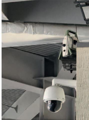
**Рис. 18.** Тахеометр на кронштейне автоматизированной системы
