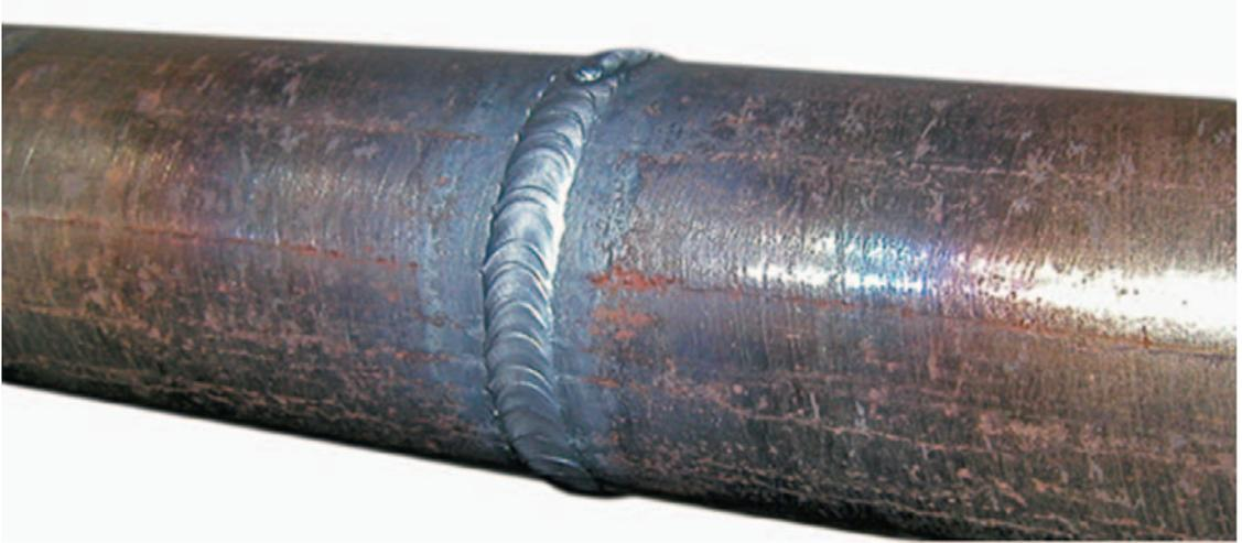
**Рис. 5.** Стыковое соединение после наплавки кромок и термообработки
