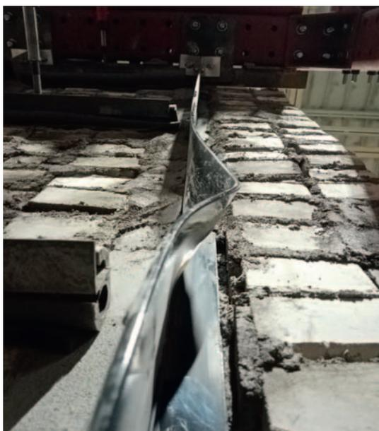
Рис. 10. Характер деформирования комбинированной конструкции (повреждения кладки и направляющих)
