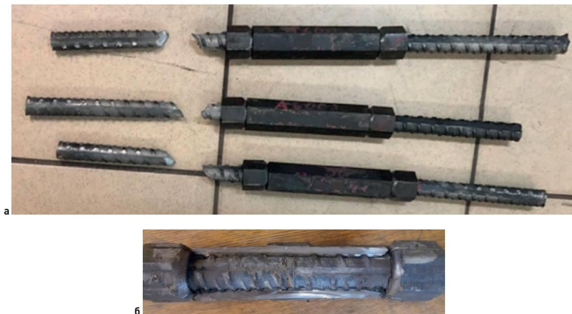
Рис. 9. а – разрушенные образцы; б – разрез соединительной муфты испытанного образца
