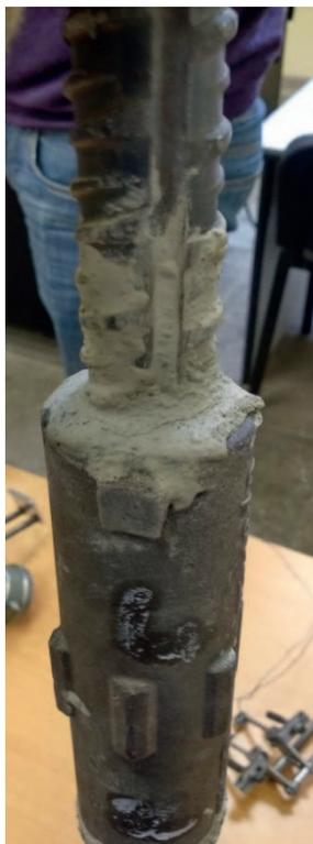
**Рис. 6.** Образец винтовых муфтовых соединений арматуры с клеевым составом на цементной основе
