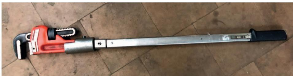
Рис. 5. Динамометрический ключ
