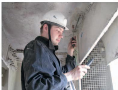
**Рис. 11.** Измерение температуры конструкции и штанги механического тензометра
