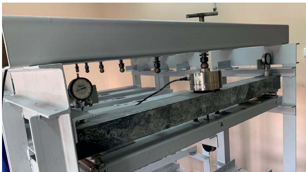
Рис. 4. Установленный образец балки для проведения длительных испытаний по определению релаксации напряжений в бетоне при изгибе
