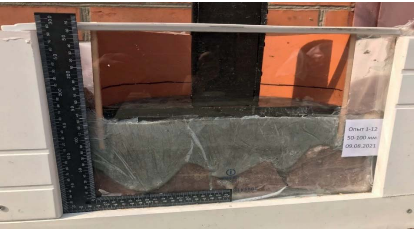
Рис. 3. Контакт БKM с грунтом с размером обломков 50–100 мм Fig. 3. Contact of BCM (bimetallic composite material) with soil of 50–100 mm sized fragments
