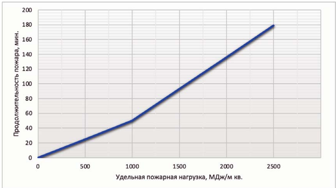
Рис. 2. Зависимость продолжительности стандартного пожара (мин) от удельной пожарной нагрузки, МДж/м²
