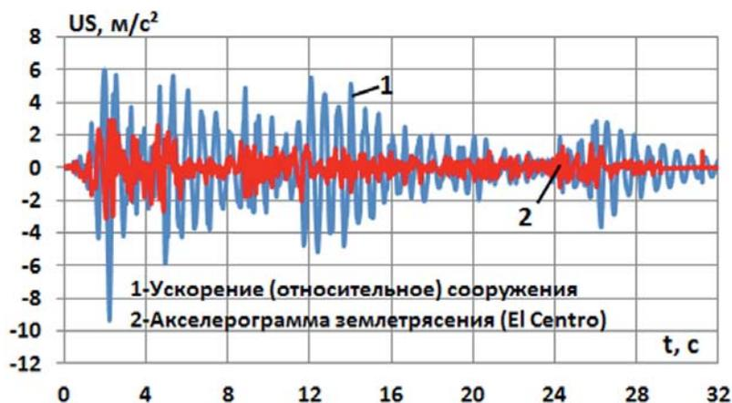
Рис. 4. Относительное ускорение верхней точки сооружения (численное дифференцирование)
