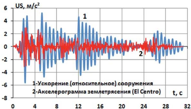
Рис. 5. Относительное ускорение верхней точки сооружения (численное интегрирование)
