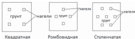
**Рис. 2.** Конфигурация нагелей при эксперименте
