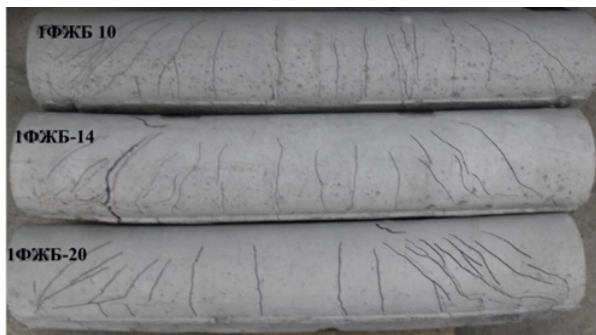
Рис. 11. Характер трещинообразования СФЖБ элементов круглого сечения при поперечном изгибе
