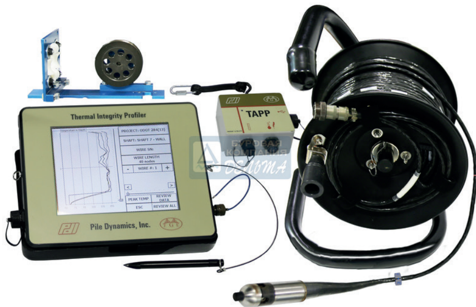
Рис. 3. Прибор TIP для оценки теплового профиля
