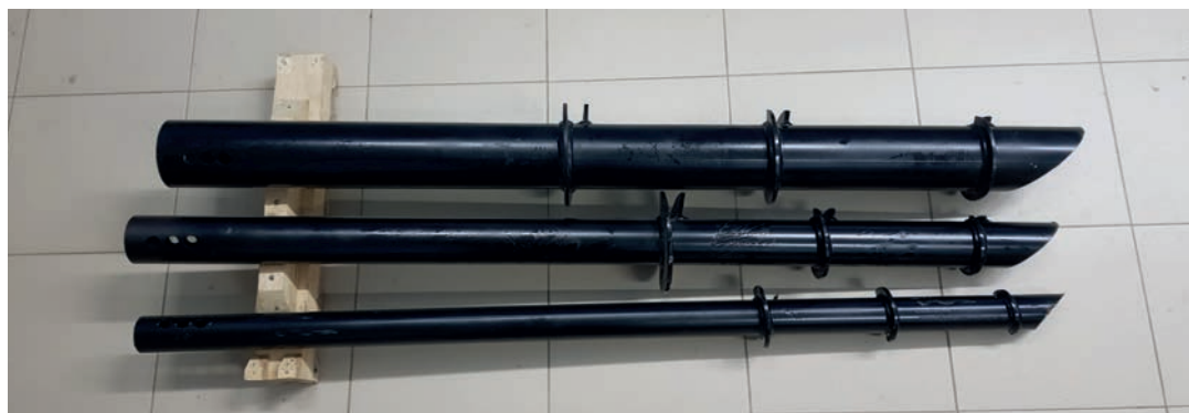
Рис. 4. Масштабированные модели металлических многолопастных ВС
