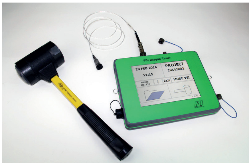
Рис. 1. PIT (pile integrity tester) проверка сплошности свай фирмы Pile Dynamics, Inc.
