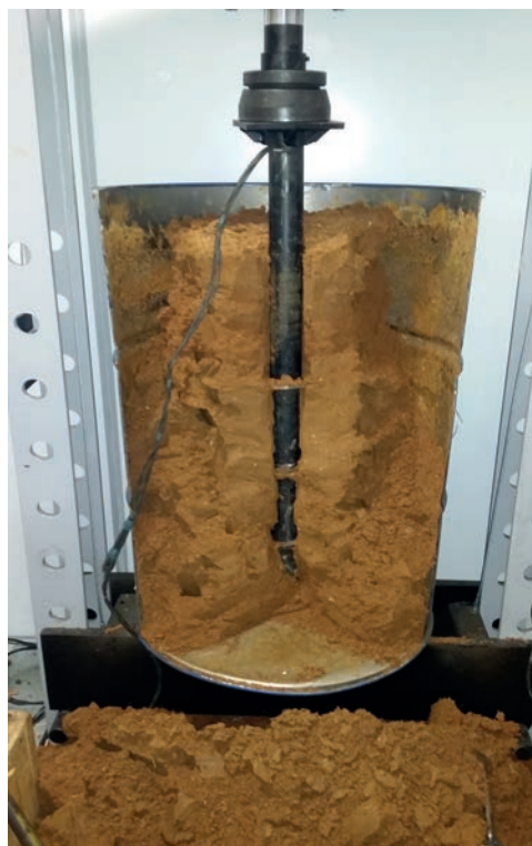
Рис. 6. Вскрытие грунтового основания
