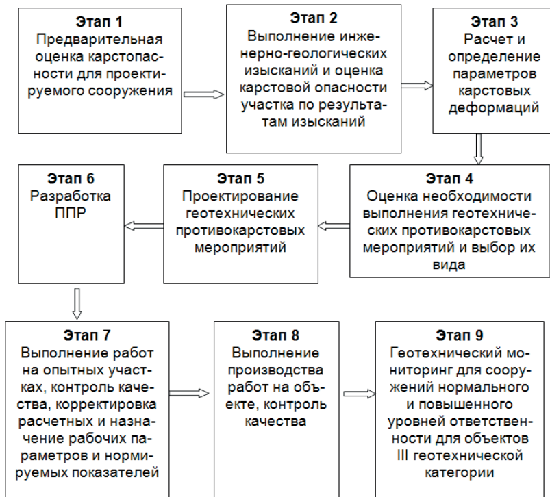
Рис. 3. Этапы выполнения регламента геотехнических противокарстовых мероприятий
