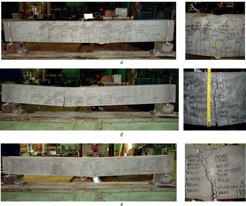
Рис. 8. Характерное разрушение моделей группы: а – B1; б – B2; в – B7
