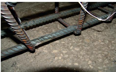
Рис. 4. Зачистка поверхности, установка тензорезистора, защита эпоксидной смолой
