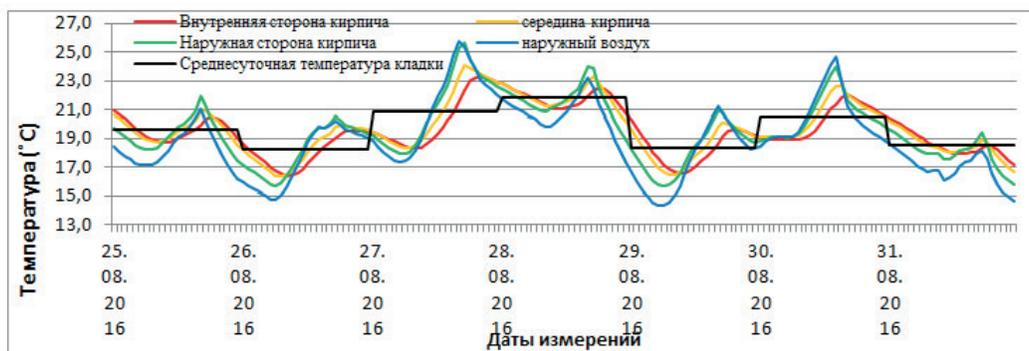
Рис. 16б. Графики изменения температуры наружного воздуха и лицевого слоя в августе 2016 г.
