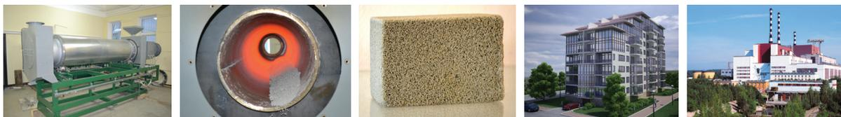
Специалистами ЦНИИСК им. В. А. Кучеренко АО «НИЦ «Строительство» разработана и запатентована комплексная технологическая линия промышленного производства энергоэффективного пеностеклокерамического гранулированного пористого материала из широко распространенных кремнистых пород, а также разработана технология и получен патент на изобретение: Способ получения теплоизоляционных блоков.
