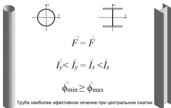
Рис. 3. Сравнение трубы и двутавра при центральном сжатии
