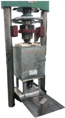
Рис. 2. Общий вид установки для испытаний бетонов при кратковременном нагреве Fig. 2. General view of the concrete test unit for short-term heating
