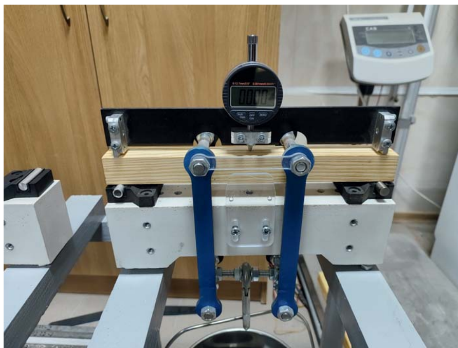
Рис. 4. Испытание деревянных образцов на четырехточечный изгиб
