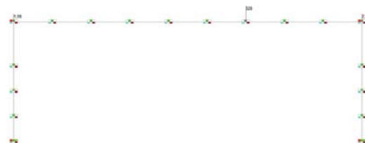
Рис. 8. Расчетная схема портала с указанием предельной нагрузки, местных осей элементов и граничных условий
