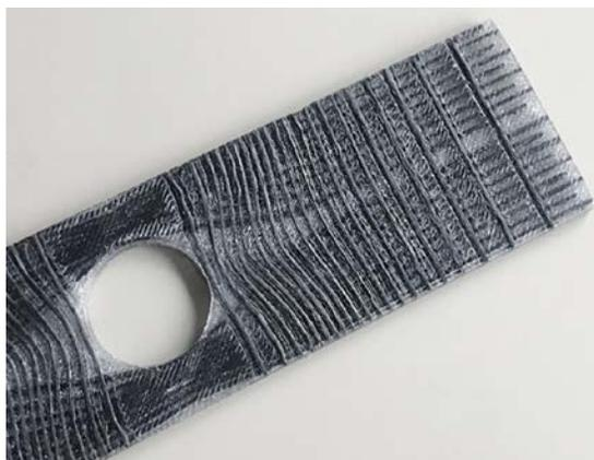
**Рис. 5.** Пример укладки волокна по сложной траектории
