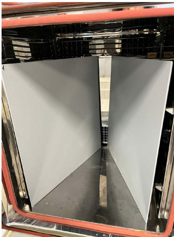
**Рис. 1.** Образцы в климатической камере TH-225 C перед началом испытаний
