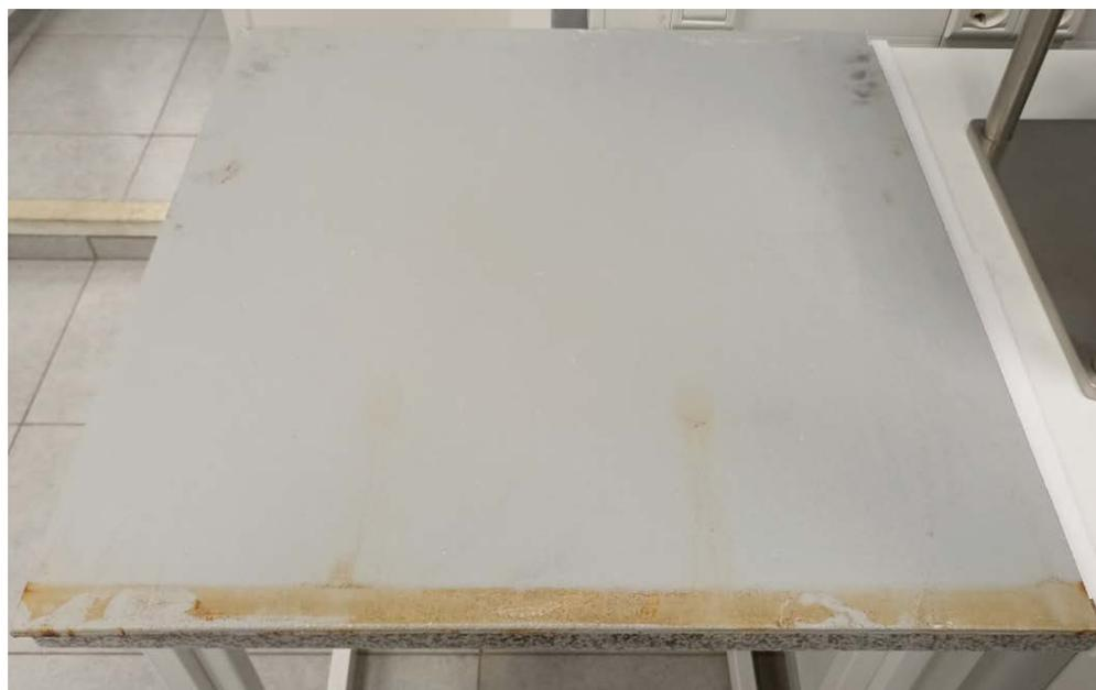
**Рис. 4.** Состояние системы покрытия после 224 циклов старения
