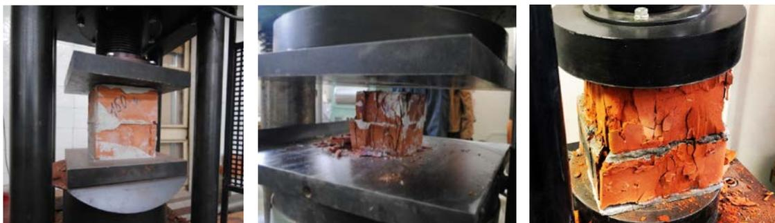
**Рис. 3.** Характер разрушения образцов кладочных изделий в прессе
