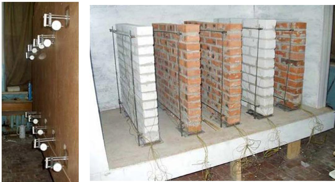
**Рис. 2.** Вид лабораторных образцов для исследования КЛТД, индикаторы часового типа
