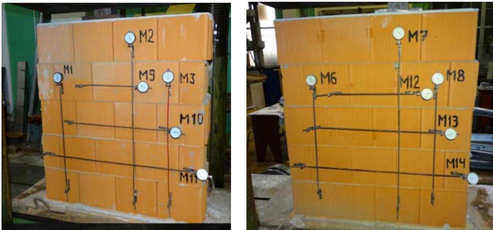
**Рис. 7.** Общий вид образца Серии № 1 при испытании на местное смятие
