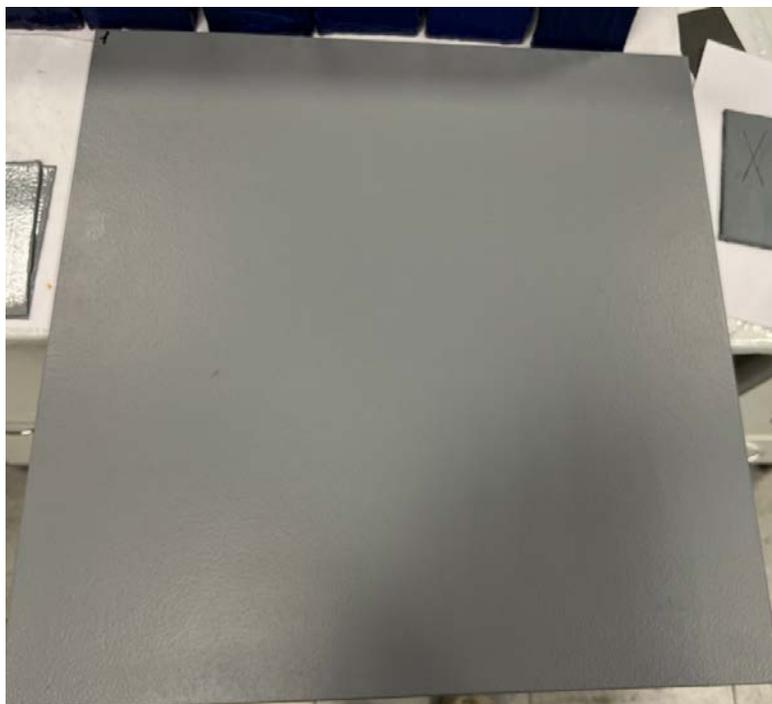
**Рис. 3.** Состояние системы покрытия после 134 циклов старения
