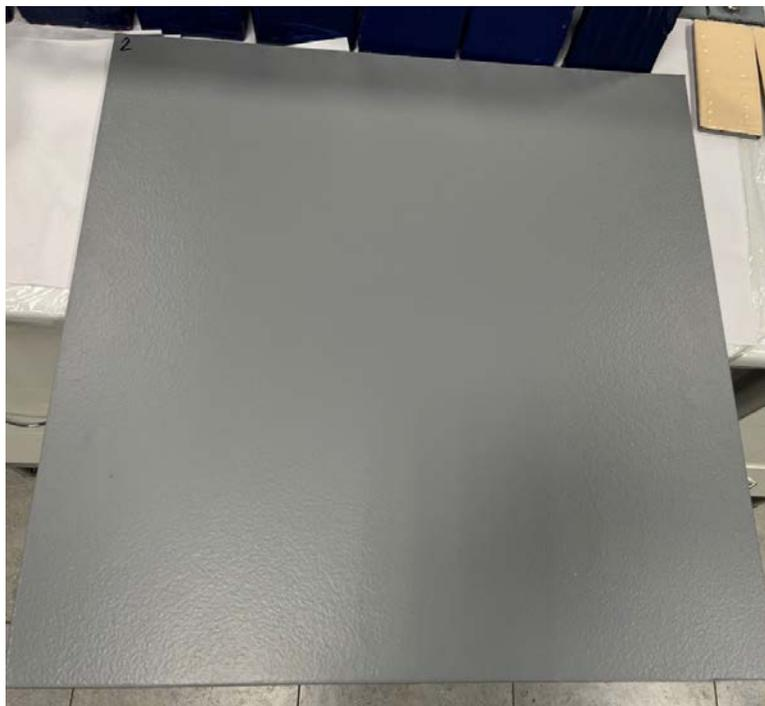
**Рис. 2.** Состояние покрытия после 45 циклов старения
