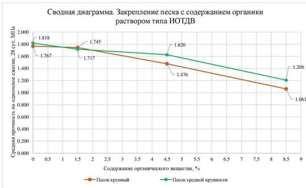
**Рис. 7.** Прочность. Закрепление песка с содержанием органики раствором типа ИОТДВ
