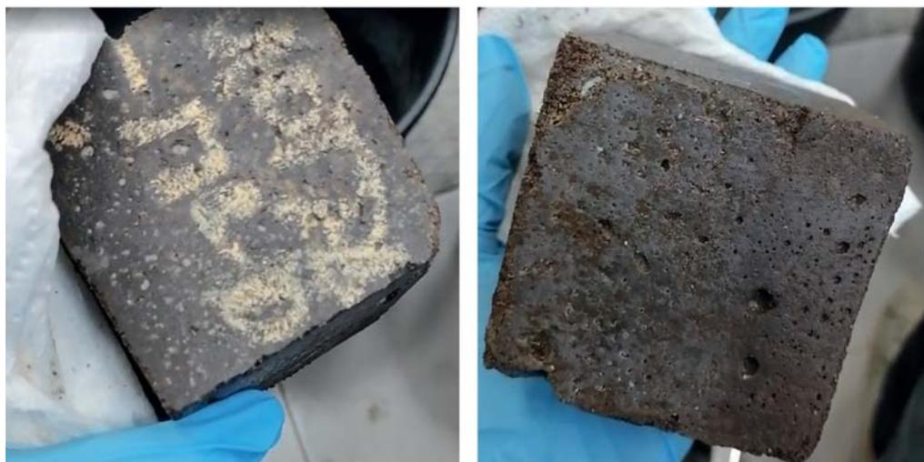
**Рис. 2.** Образец с составом: раствор типа ИОТДВ + песок средней крупности с добавлением органики 7–10 %
