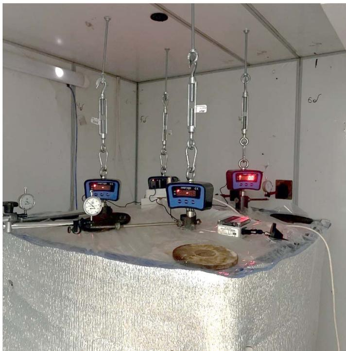
**Рис. 7.** Общий вид экспериментального лотка для определения негативной силы
