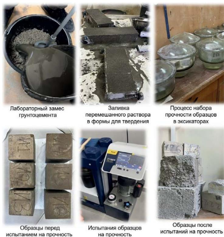
**Рис. 1.** Процесс изготовления, твердения и испытания образцов грунтоцемента
