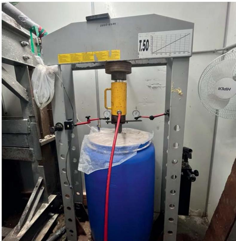
Рис. 5. Общий вид экспериментального лотка для определения несущей способности
