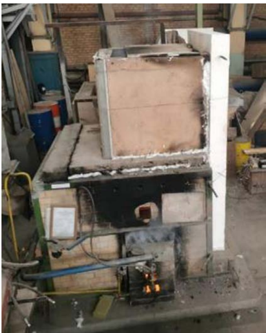
Рис. 10. Фрагмент конструкции стены с нанесенной огнезащитной краской во время испытаний Fig. 10. Fragment of a wall structure with applied fire-retardant paint during testing
