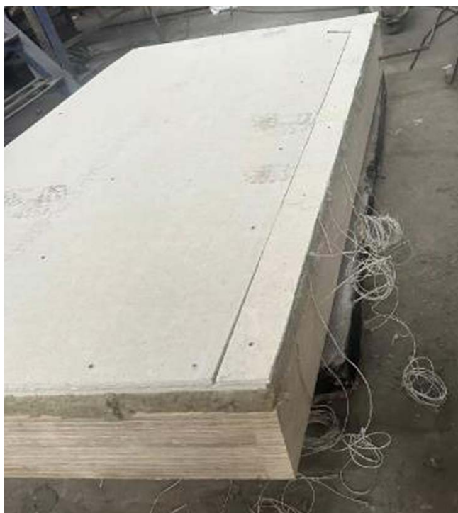
Рис. 15. Фрагмент конструкции стены с минераловатной плитой и двумя слоями ГКЛ перед испытаниями Fig. 15. Fragment of a wall structure with a mineral wool slab and two plasterboard sheets before testing
