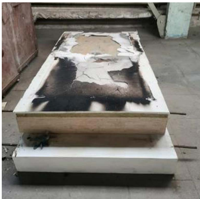
Рис. 17. Фрагмент конструкции стены с минераловатной плитой и двумя слоями ГКЛ после испытаний Fig. 17. Fragment of a wall structure with a mineral wool slab and two plasterboard sheets after testing
