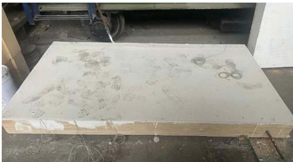
Рис. 12. Фрагмент конструкции стены с двумя слоями ГКЛ перед испытаниями Fig. 12. Fragment of a wall structure with two plasterboard sheets before testing
