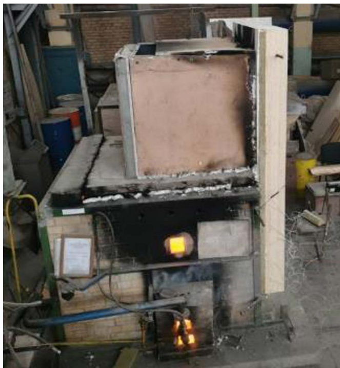
Рис. 16. Фрагмент конструкции стены с минераловатной плитой и двумя слоями ГКЛ во время испытаний Fig. 16. Fragment of a wall structure with a mineral wool slab and two plasterboard sheets during testing
