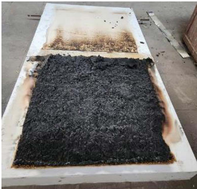
Рис. 11. Фрагмент конструкции стены с нанесенной огнезащитной краской после испытаний Fig. 11. Fragment of a wall structure with applied fire-retardant paint after testing
