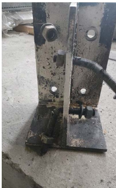
Рис. 7. Металлический узел крепления после проведения огневых испытаний Fig. 7. Metal attachment joint after fire testing
