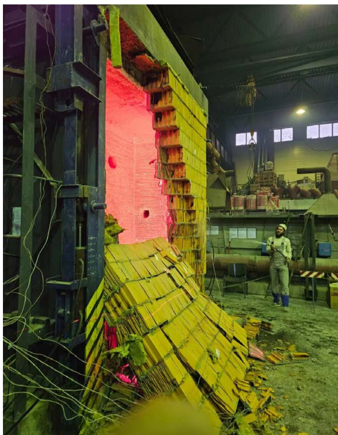
Рис. 8. Разрушение образца кладки из крупноформатных керамических камней Fig. 8. Destruction of a masonry sample made of large ceramic blocks
