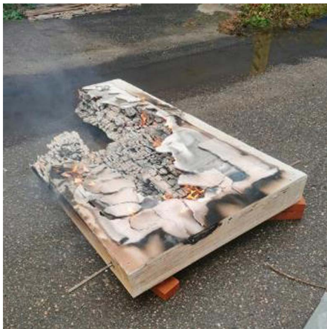
Рис. 14. Фрагмент конструкции стены с двумя слоями ГКЛ после испытаний Fig. 14. Fragment of a wall structure with two plasterboard sheets after testing
