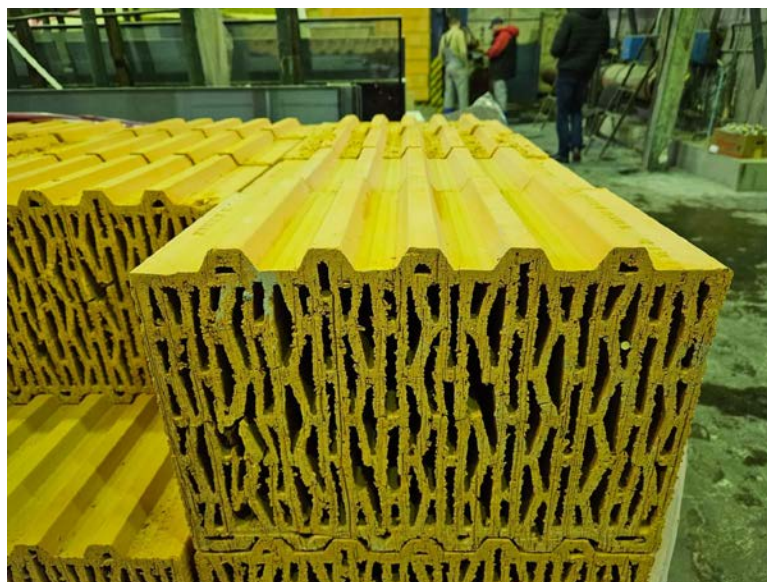
Рис. 4. Камень керамический поризованный пазогребневый марки Porotherm 38 Thermo Fig. 4. Porotherm 38 Thermo porous groove ceramic block
