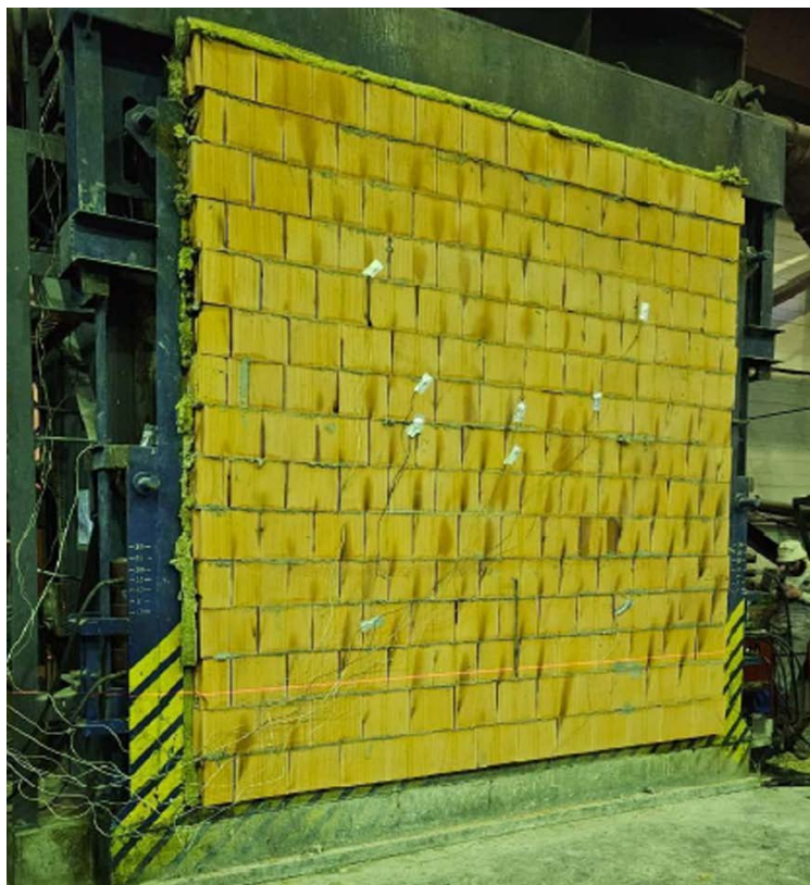
Рис. 3. Общий вид конструкции образца кладки из крупноформатных керамических камней перед испытанием Fig. 3. General view of a masonry sample made of large ceramic blocks before testing
