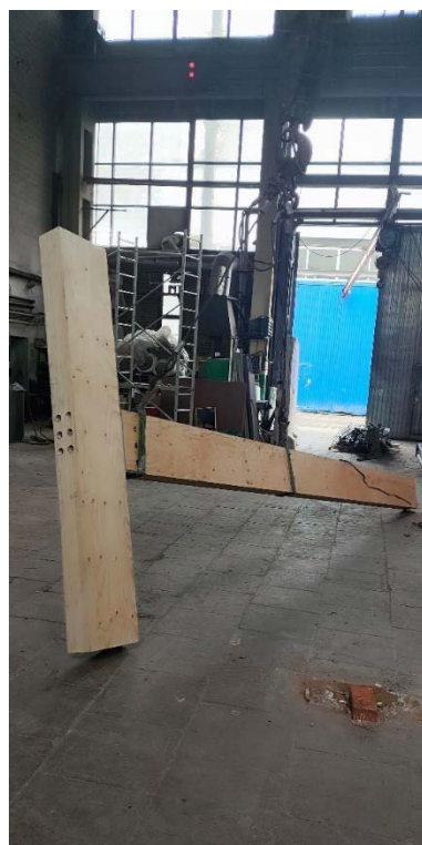
Рис. 5. Внешний вид конструкции узлов «балка – балка» и «балка – колонна» Fig. 5. Beam-beam and beam-column joints
