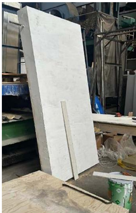
Рис. 9. Фрагмент конструкции стены с нанесенной огнезащитной краской перед испытаниями Fig. 9. Fragment of a wall structure with applied fire-retardant paint before testing
