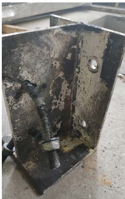
Рис. 7. Металлический узел крепления после проведения огневых испытаний Fig. 7. Metal attachment joint after fire testing
