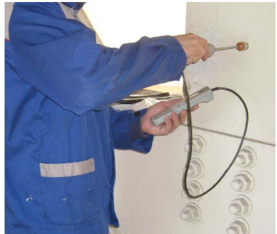
Рис. 3. Измерение температуры конструкции контактным термометром ТК5-01П Fig. 3. Temperature measurements with a TK5-01P contact thermometer
