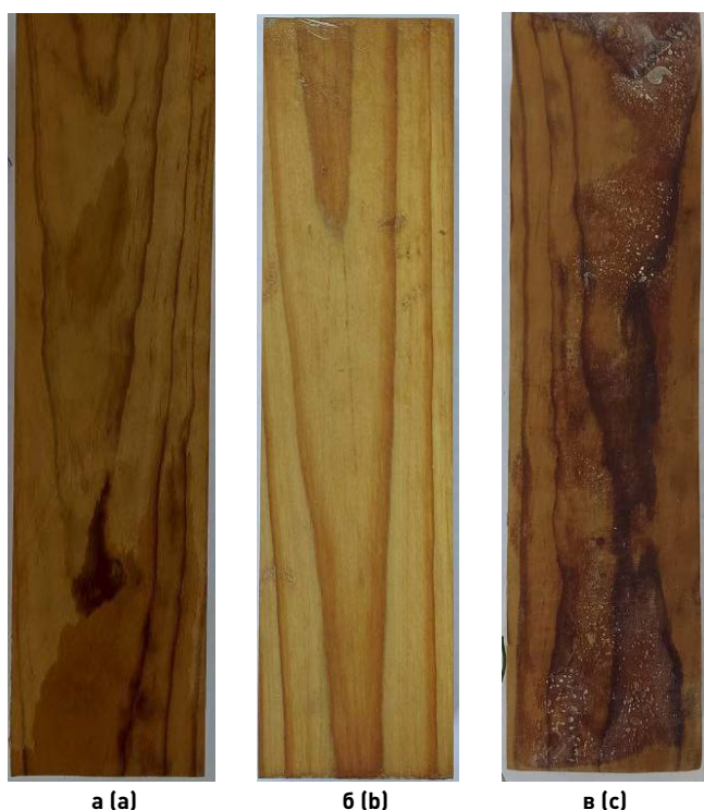
Рис. 1. Общий вид образцов: а – брусок 50 × 50 × 200 мм из термообработанной сосны; б – брусок 50 × 50 × 200 мм из стабилизированной сосны; в – брусок 50 × 50 × 200 мм из термообработанной и стабилизированной сосны Fig. 1. General view of the specimens: а – 50 × 50 × 200 mm block of thermally treated pine; б – 50 × 50 × 200 mm block of stabilized pine; в – 50 × 50 × 200 mm block of thermally treated and stabilized pine
