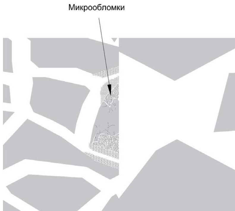
Рис. 4. Разрушение части стенки пор с образованием микрообломков Fig. 4. Partial fracture of the pore wall with the formation of microfragments
