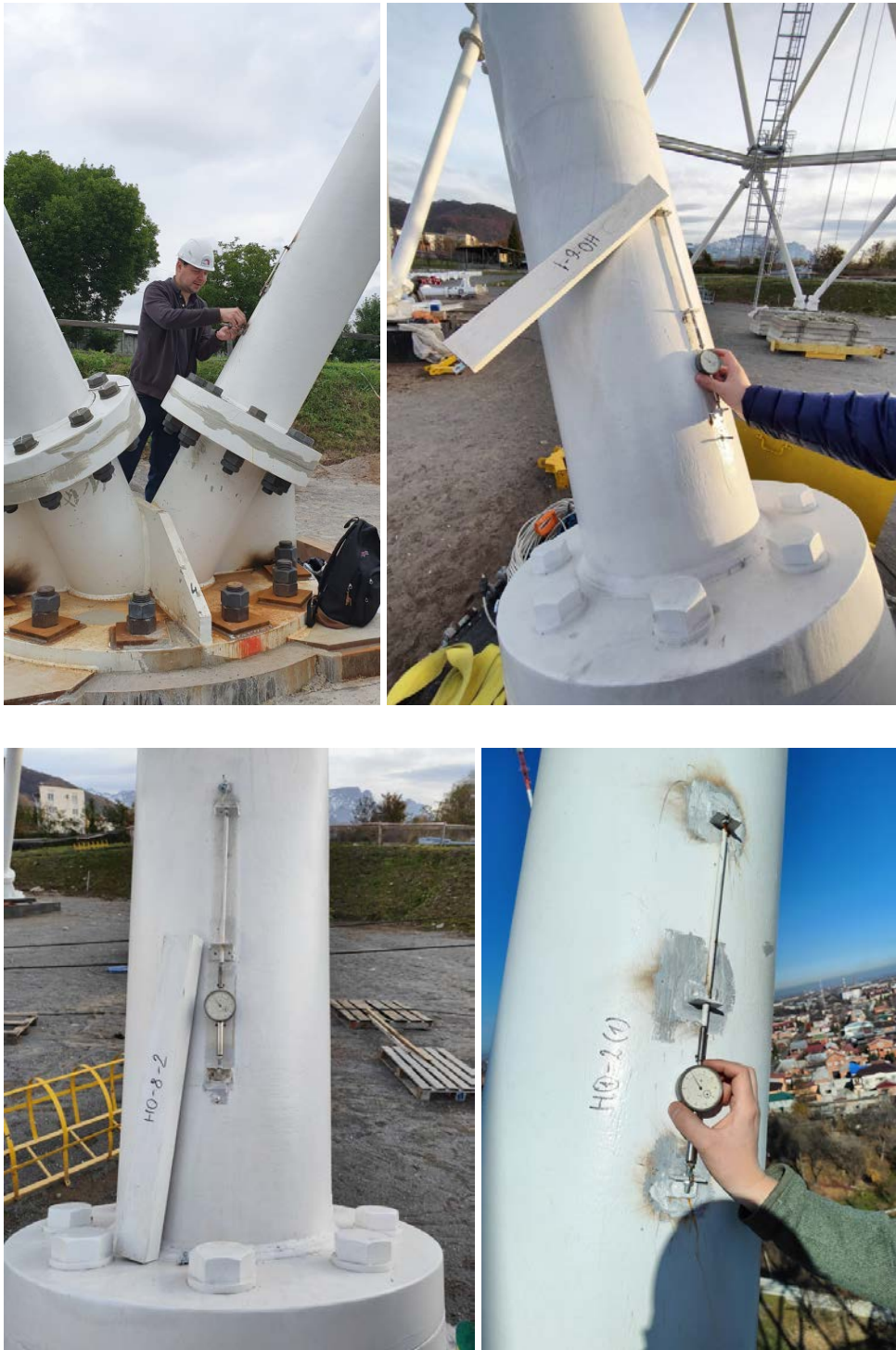
Рис. 12. Снятие показаний с деформометров Fig. 12. Taking readings from strain gauges
