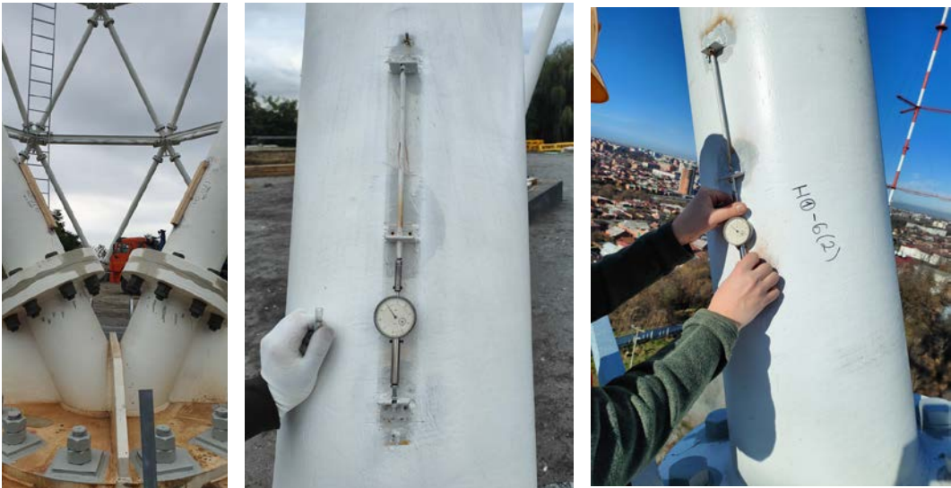
Рис. 2. Прикрепление приборов ТМИ-500М к различным элементам конструкций Fig. 2. Attachment of TMI-500M instruments to various structural elements
