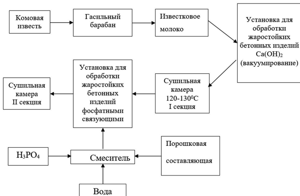
Рис. 3. Технологическая схема структурной модификации жаростойких композитов Fig. 3. The flowchart of the structural modification of heat-resistant composites
