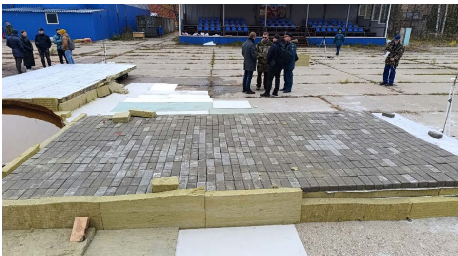
Рис. 1. Образец 1-го типа перед началом испытаний Fig. 1. Sample 1 before testing
