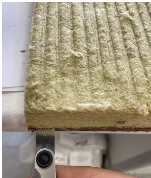
Рис. 5. Состояние системы покрытия после 75 циклов старения
