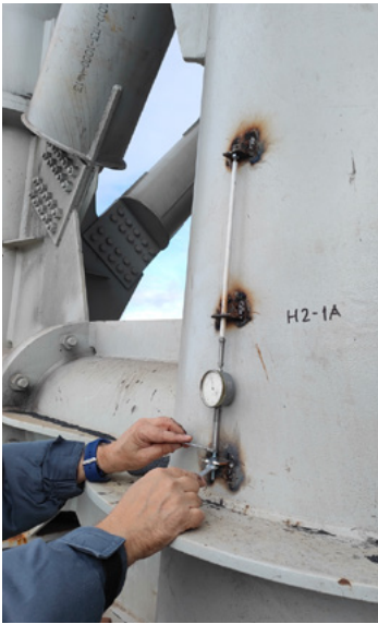
Рис. 7. Настройка механического тензометра перед измерением на конструкциях башни Fig. 7. Adjusting the mechanical strain gauge before measurement on tower structures
