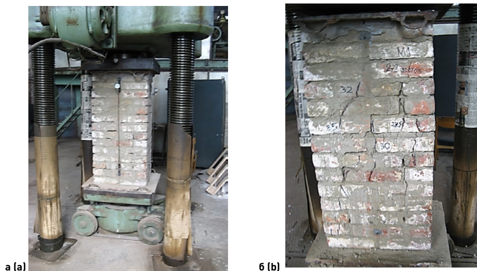
Рис. 5. Образец серии БТ-Иэп-тр: а – в процессе испытания; б – после испытания
