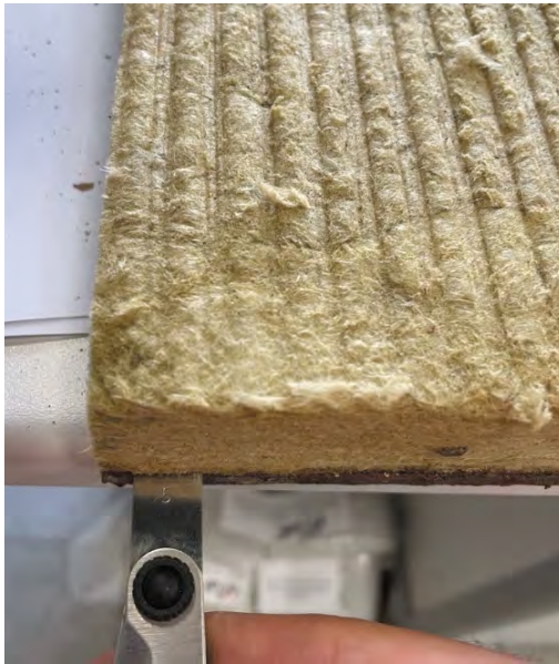
Рис. 5. Состояние системы покрытия после 75 циклов старения
