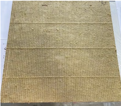
Рис. 3. Состояние системы покрытия после 25 циклов старения
