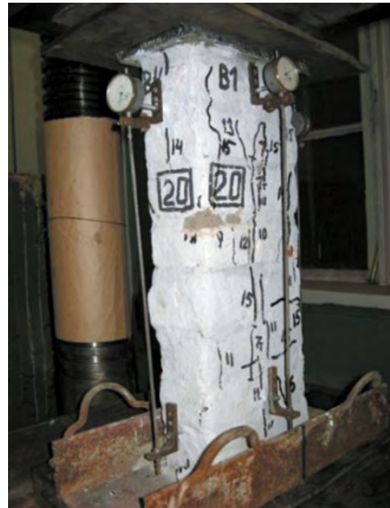
Рис. 4. Образец серии М3 после испытаний на сжатие Fig. 4. M3 series masonry sample after compression tests
