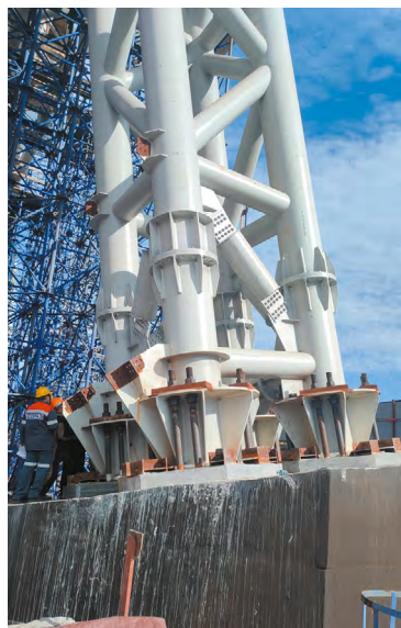
Рис. 8. Установка тензометров на отм. +1,700 (на высоте 1,7 м от отм. \pm 0,000 ) в сечениях 1/A и 1/Г
