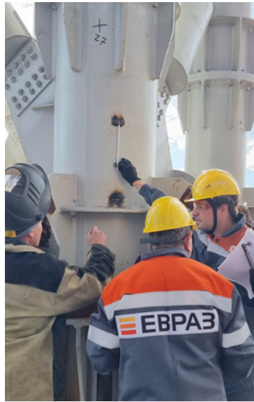
Рис. 8. Установка тензометров на отм. +1,700 (на высоте 1,7 м от отм. \pm 0,000 ) в сечениях 1/А и 1/Г
