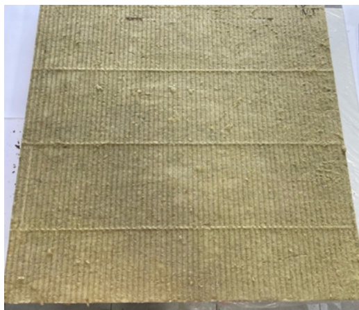
Рис. 3. Состояние системы покрытия после 25 циклов старения
