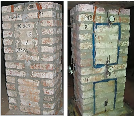
а (a) б (b) Рис. 11. Образцы серии М5-МС после испытания на местное сжатие: а – № 3-9с; б – № 4-8с Fig. 11. M5-MS series masonry samples after local compression tests: а – No. 3-9s; б – No. 4-8s
