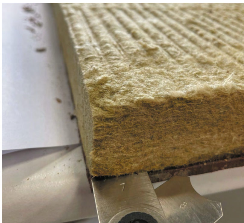
Рис. 7. Состояние системы покрытия после 125 циклов старения Fig. 7. Coating system after 125 aging cycles
