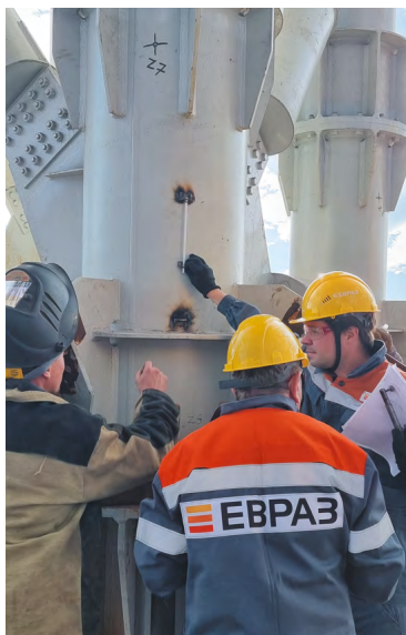
Рис. 8. Установка тензометров на отм. +1,700 (на высоте 1,7 м от отм. \pm 0,000 ) в сечениях 1/A и 1/Г
