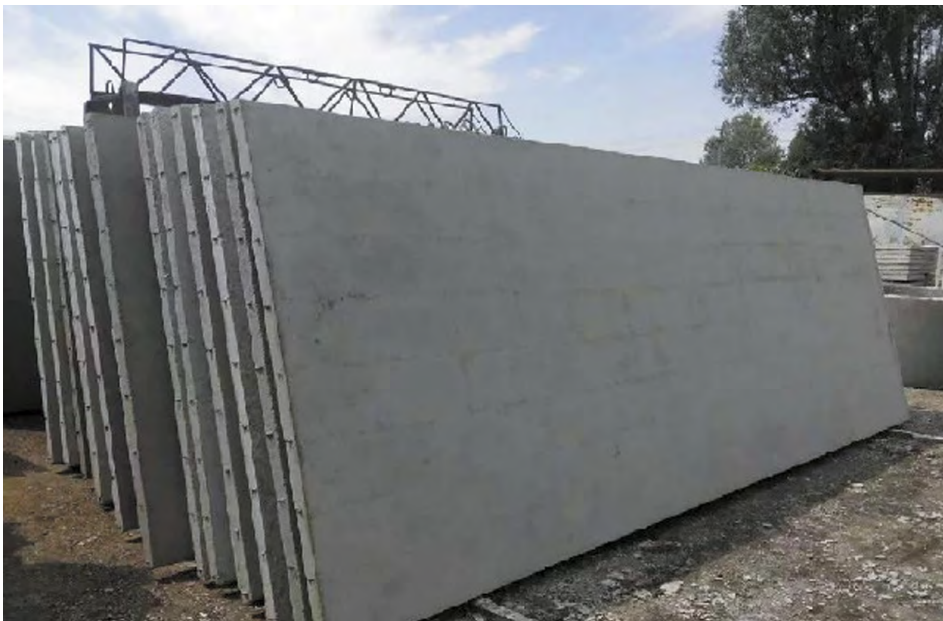
Рис. 2. Общий вид облицовочных плит марки ПКН60.20 (источник: https://irkutsk.pkfcvet.ru/media/uploads/images/zhelezobetonnye_plity_oblicovki_kanalov.jpg )
