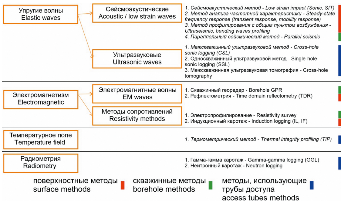
Рис. 1. Методы неразрушающего контроля качества свай (с изменениями, из [6]), сгруппированные согласно используемым физическим принципам
