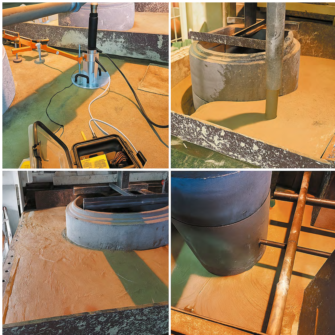
Рис. 5. Исследования ИКТ (Gelsenkirchen) в масштабных тестовых траншеях с моделями труб [5] Fig. 5. Research by IKT (Gelsenkirchen) in large-scale test trenches with pipe models [5]
