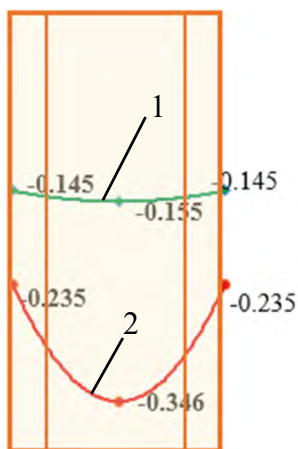
Рис. 10. Эпюры вертикальных деформаций \epsilon \times 10^{-2} в средней по высоте части образца № 1-4д серии М4-ЦС при уровнях нагрузки: 1 - N = 0,5N_u ; 2 - N = 0,8N_u
