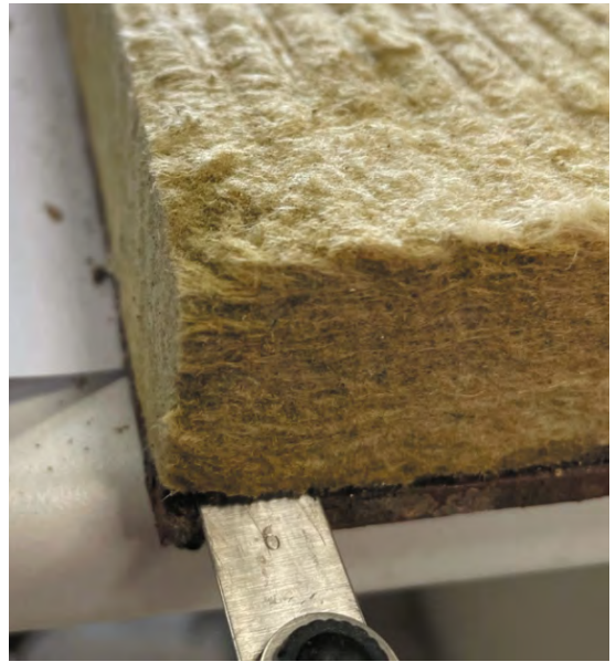
Рис. 6. Состояние системы покрытия после 100 циклов старения
