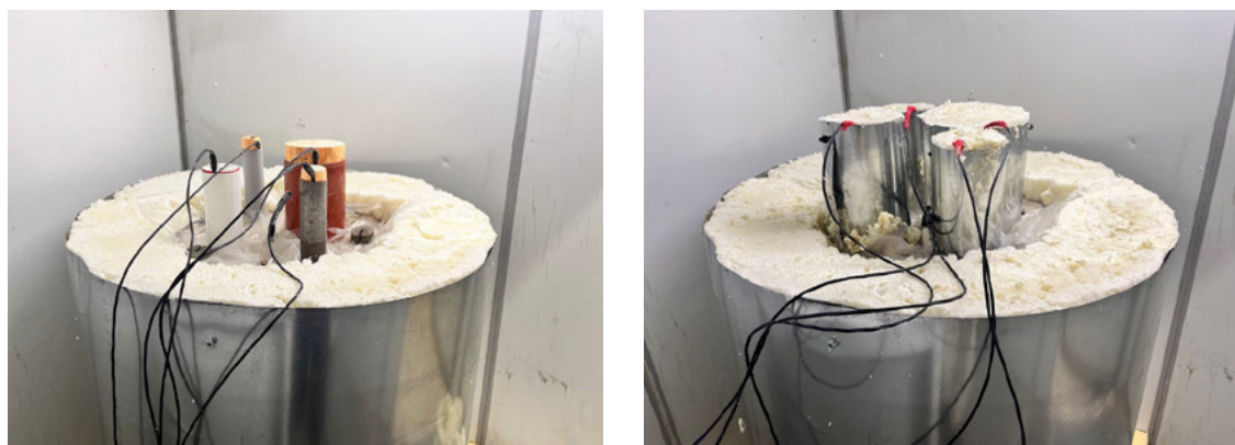
а (a) Рис. 2. Общий вид экспериментального лотка: а – без теплоизоляции оголовков; б – с теплоизоляцией оголовков (фото: И.А. Дымченко)
