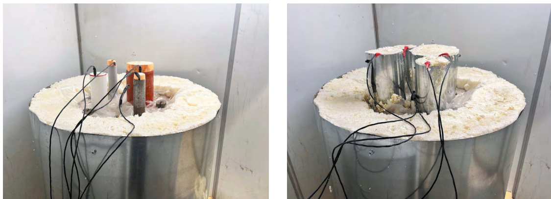
а (a) б (b) Рис. 2. Общий вид экспериментального лотка: а – без теплоизоляции оголовков; б – с теплоизоляцией оголовков (фото: И.А. Дымченко)
