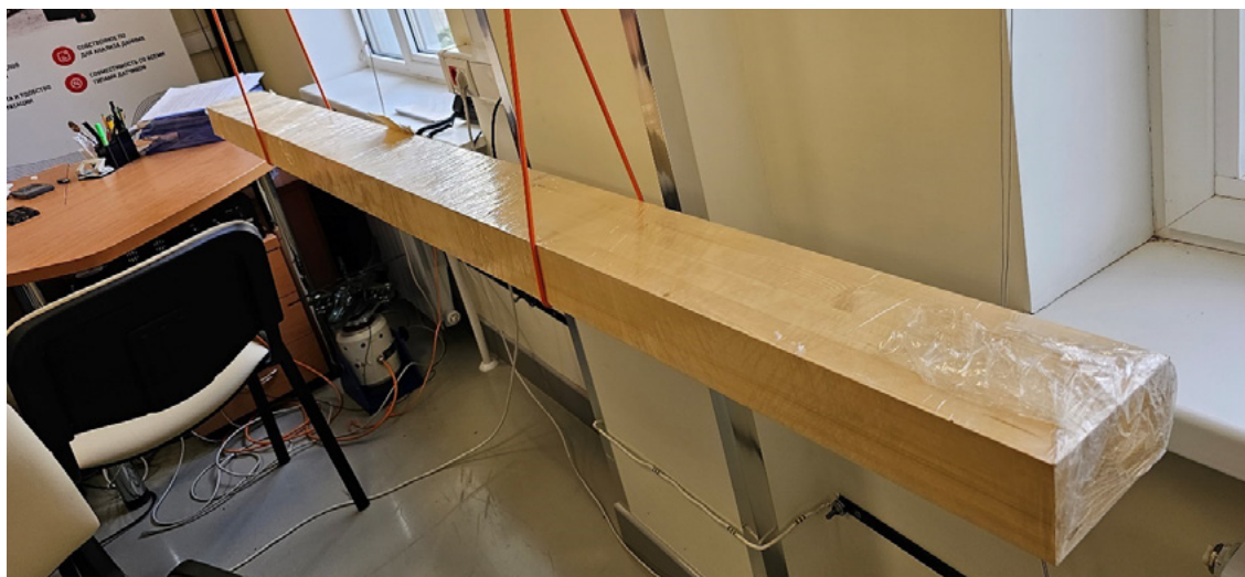
Рис. 6. Вывешивание деревянного образца размером 2200 × 150 × 75 мм Fig. 6. Hanging a wooden sample measuring 2200 × 150 × 75 mm
