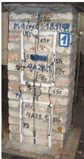
Рис. 9. Образец серии М4-ЦС после испытаний на сжатие равномерно распределенной нагрузкой Fig. 9. M4-TsS series masonry sample after compression tests with a uniformly distributed load
