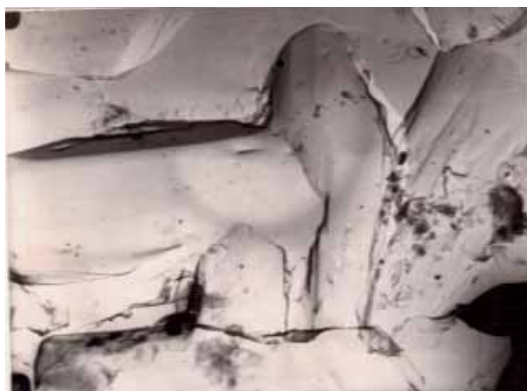
Рис. 2. Электронно-микрофотография участка крупного кристалла из пробы, взятой из отливки из высокопрочного гипса с 5 вес. % извести негашеной молотой
