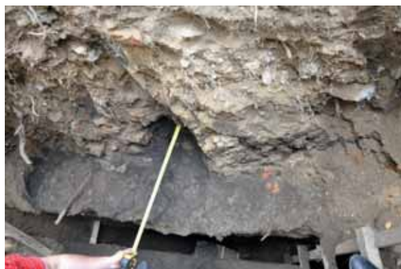
Рис. 7. Линза цементного раствора на границе слоев [10] Fig. 7. Lens of grout at the layers contact [10]
