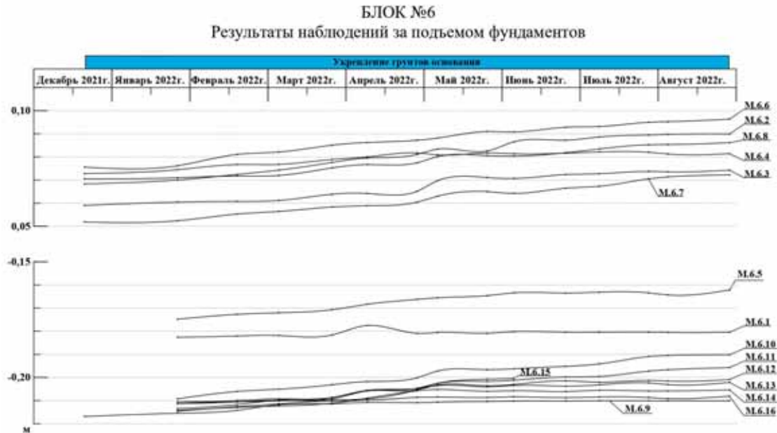
Рис. 11. Динамика подъема фундаментных плит блока № 6 Fig. 11. Lifting trend of the foundation slabs of the 6 block
