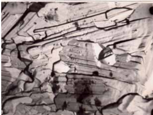
Рис. 4. Электронно-микрофотография пробы гипсовой отливки из высокопрочного гипса с добавкой 10 вес. % извести негашеной молотой, хранившейся в течение 3-х месяцев в среде с 80 % влажностью Fig. 4. Electron micrograph of a sample of a high-strength plaster casting with an additive of 10 wt. % of ground quicklime, stored for 3 months in an environment with 80 % humidity
