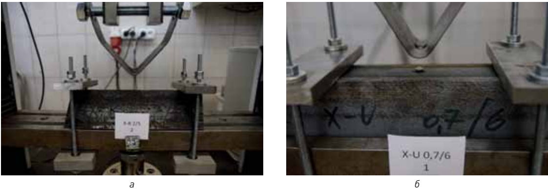
Рис. 6. Характерные механизмы разрушения в испытанных образцах Fig. 6. Typical failure modes observed in the tested specimens
