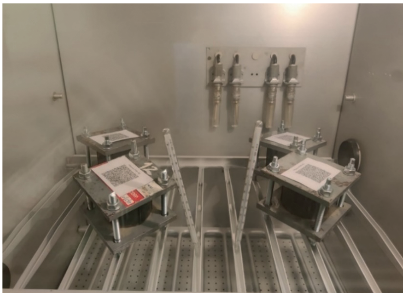
Рис. 2. Резинометаллические опоры, расположенные в рабочей зоне климатической камеры, в процессе испытаний на ускоренное старение Fig. 2. Rubber bearings, located in the working area of the climatic chamber, during accelerated aging tests
