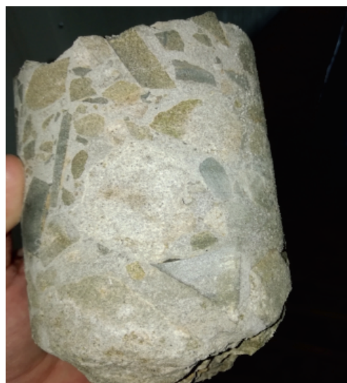
Рис. 4б. Керны – высоконапорная инъекция Fig. 4б. Cores – high-pressure injection
