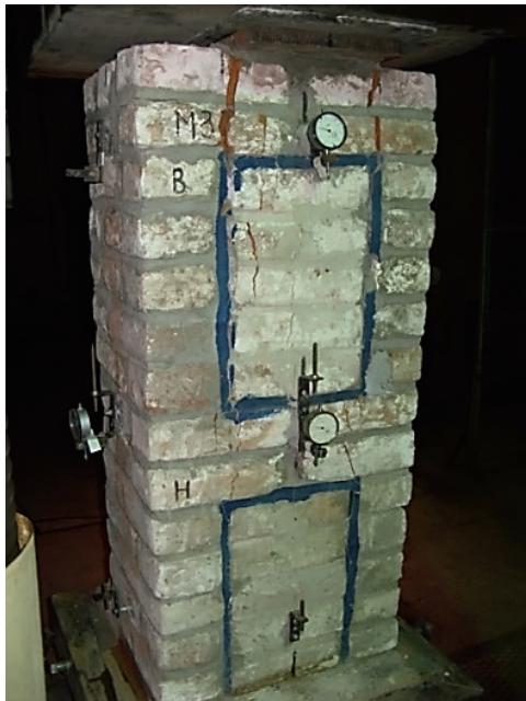
Рис. 12. Образец из исторического кирпича, получивший трещины после 1-го этапа испытаний на местное сжатие (а), образец, усиленный инъекцией раствора и косвенным армированием, после 2-го этапа (б) Fig. 12. Sample made of historical brick, which received cracks after the 1st stage of local compression tests (a), reinforced with mortar injection and indirect reinforcement, after the 2nd stage (b)
