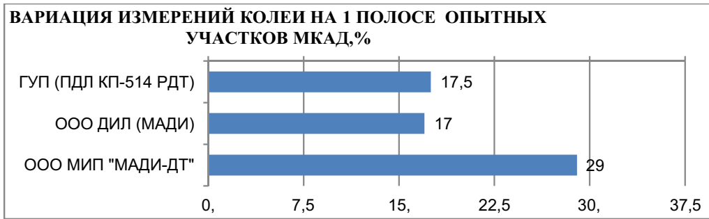
Рис. 5. Усредненные значения коэффициентов вариации глубины колеи по замерам различных передвижных лабораторий на экспериментальных участках МКАД
