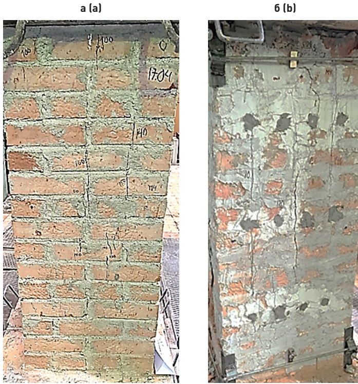
Рис. 7. Образец серии Совр-ЦС-И: а – после 1-го этапа; б – после 2-го этапа Fig. 7. Sample of the Sovr-CS-I series: a – after the 1st stage; b – after the 2nd stage
