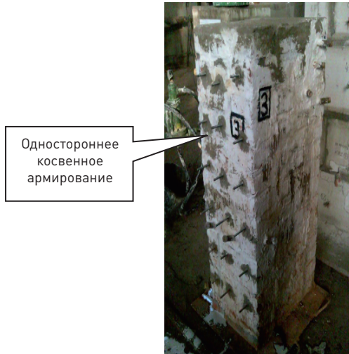
Рис. 10. Усиление образца серии Забут-МС инъекцией раствора и односторонним конструктивным косвенным армированием
