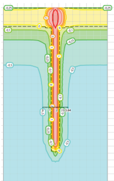
Рис. 1. Температурное распределение ГЦЭ диаметром 0,6 м в песке на 3 сутки
