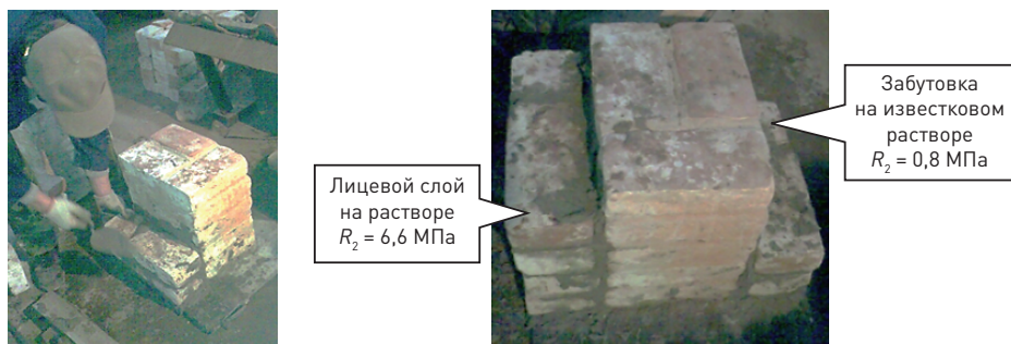
Рис. 8. Изготовление образцов серий Забут-ЦС и Забут-МС Fig. 8. Manufacturing of samples of the Zabut-CS and Zabut-MS series
