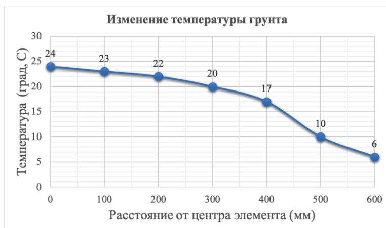
Рис. 3. График изменения температуры грунта в зависимости от расстояния до оси зоны Fig. 3. Graph of soil temperature change depending on the distance to the zone axis
